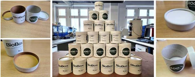
*Prototypen-Serie der BioBox – eine biogene und recyclingfähige Verpackung aus 100 % Papier*
