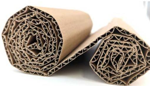
*Vergleich des Umformverhaltens herkömmlicher (oben) und flexibilisierter (unten) einwelliger Wellpappe mit C-Welle*
