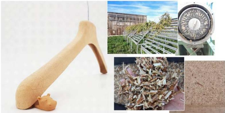
*Bügeldemonstrator (links), Aufbereitungsstufen der Hopfenreben (rechts)*
