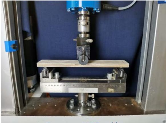
*3-Punkt-Biegeprüfung eines Werkstoffverbundes aus Birkenholz-furnier und Basaltfasergewebe-verstärktem Phenolharz*
