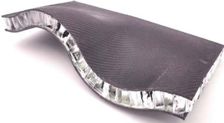
*Formteil in Wabenbauweise mit flexibilisierten Aluminiumwabenkern nach dem FlexCore-Verfahren sowie Epoxidharz-Decklagen der Gurit Services AG*
