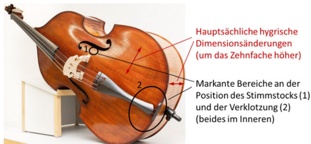
Anisotropes Quell- und Schwindverhalten der Holzbauteile im Streichinstrument (Bsp. Kontrabass) sowie markante Bereiche mit Spannungsspitzen (Rissbildung)
