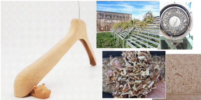
Bügeldemonstrator (links), Aufbereitungsstufen der Hopfenreben (rechts)
