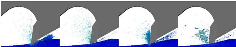
Bildfolge zeigt vier Bonded-Particle-Simulationen mit unterschiedlichen Materialdefinitionen die zu einer Variation der gebildeten Agglomeratgröße und Bewegung der Agglomerate führt
