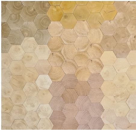
Vorhaben HolzpfasterStanzen – Exemplarische Musterfläche aus hexagonalen Klotzgeometrien
