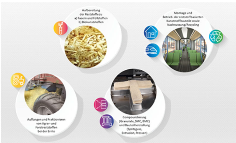
Darstellung der Teilprozessschritte von EnviroPlast
