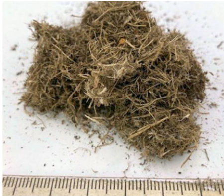
TMP-Faserstoff aus Hopfen (Foto: S. Tech)
