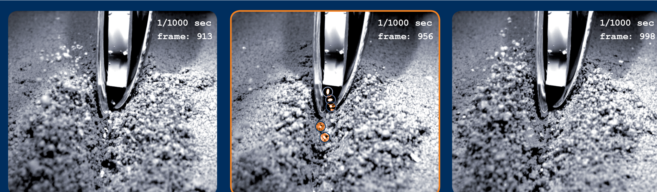
Analyse der Saatgutablage, Highspeedaufnahmen (1000 fps)
