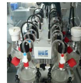
RAMOS inklusive 8 Messkolben mit Suspension von Helianthus annuus
