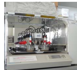
RAMOS inklusive 8 Messkolben mit Suspension von Helianthus annuus
