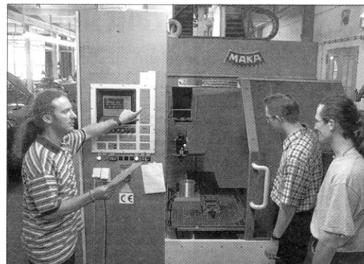
Fünfachsgesteuerte CNC-Fräsmaschine MAKA am Lehrstuhl Holz- und Faserwerkstofftechnik
