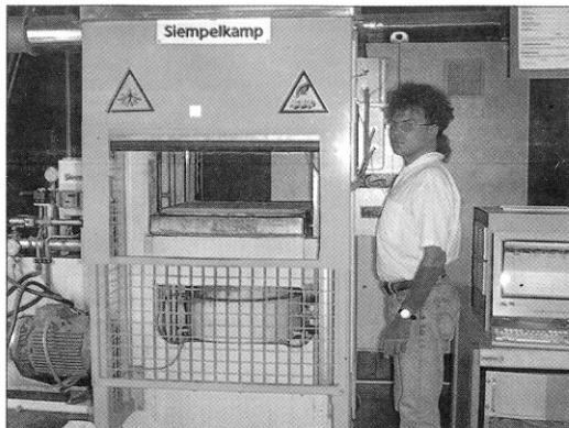
Computergesteuerte Laborpresse „Marke Siempelkamp“ im Holztechnikum der TU Dresden
