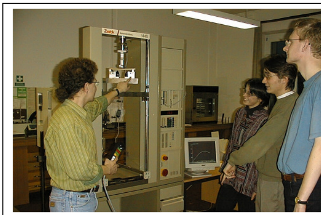
Studenten bei der Bestimmung von Werkstoffkenngrößen an der Festigkeitsprüfmaschine der Firma Zwick
