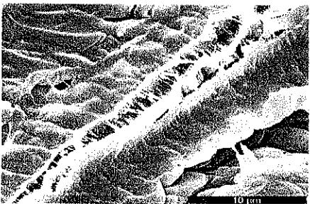
Abb. 13: 33% gestauchte Probe, Mikroriss zwischen zwei Fasern
