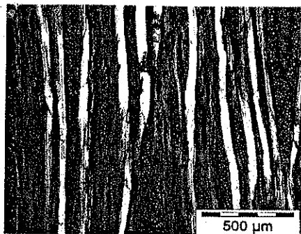
Abb. 3: ungestauchte Probe, Tangentialschnitt, longitudinale Ausrichtung der Fasern und Gefäße (Gefäße hell)
