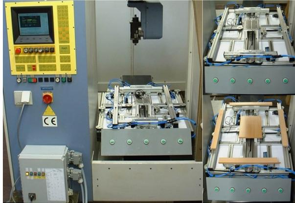
Rahmenaufsatz auf CNC-BAZ: Gesamtsystem und Beispiele für Bearbeitungsschritte
