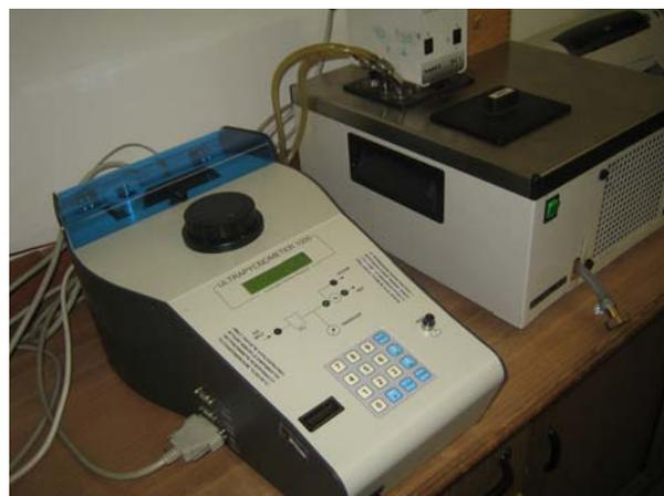
ten Messgases wie Helium oder Stickstoff. Dabei wird in einer Messkammer mit bekanntem Volumen die durch einen eingebrachten Probekörper bewirkte Gasverdrängung über die Messung des veränderten Drucks bestimmt.
