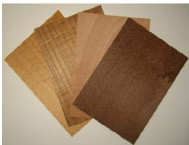
Thermisch vergütete Ahorn- und Rotbuchenfurniere, Vergütungstemperaturen 170 °C bzw. 190 °C
