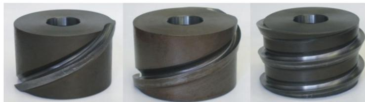
*Geometrie und Schneidprinzip des Helix- bzw. Schraubfräsers mit extremen Werkzeug-Neigungswinkeln  $\lambda_s$*
