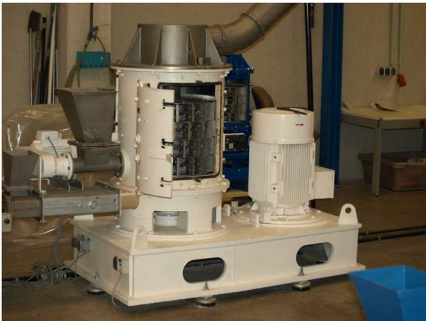
*Trockenzerfaserungsaggregat - Eine mögliche Alternative zur Nasszerfaserung*
