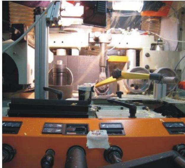
Schalldruckpegel  $L_{pA}$  über dem Werkzeug-Neigungswinkel  $\lambda_s$  unter Beachtung der unterschiedlichen mittleren Spannungsdicke  $h_m$  von Fichte (links) und Versuchsstand mit Schraubfräser und nach oben gerichteten Spanauswurf (rechts)
