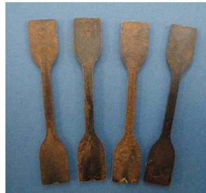
VOC-Chromatogram von Lignin (links) und Prüfstäbe aus Kraftlignin (rechts)
