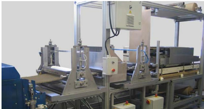
*Abb.: Versuchsanlage zur kontinuierlichen Plattenherstellung*
