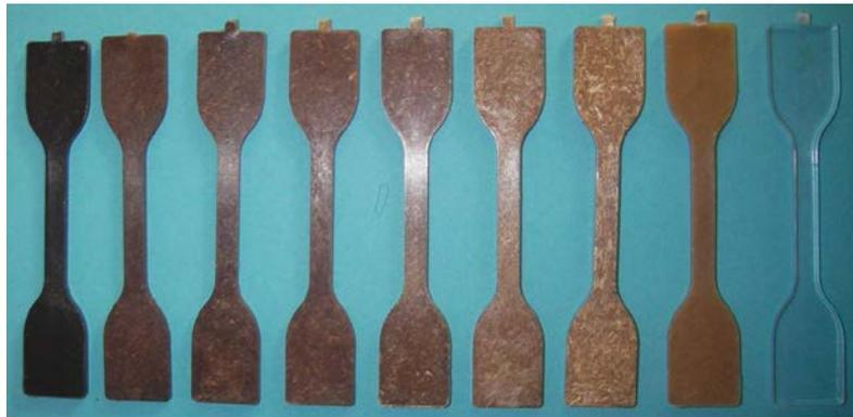
*Beispiele der Werkstoffentwicklung (links: Holzwerkstoffe und Dämmplatten; rechts: Bio-Verbundwerkstoffe)*
