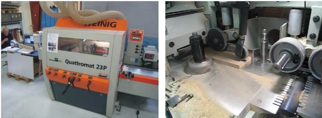
*Links: Versuchsstand (Weinig Quattromat 23P); rechts: Zerspanungssituation an der vertikalen Werkzeugspindel (ohne Spanhaube)*
