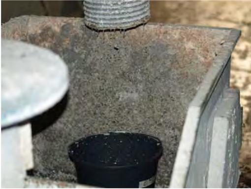
*Auffangen der abgetrennten Granulate zur weiteren Untersuchung.*
