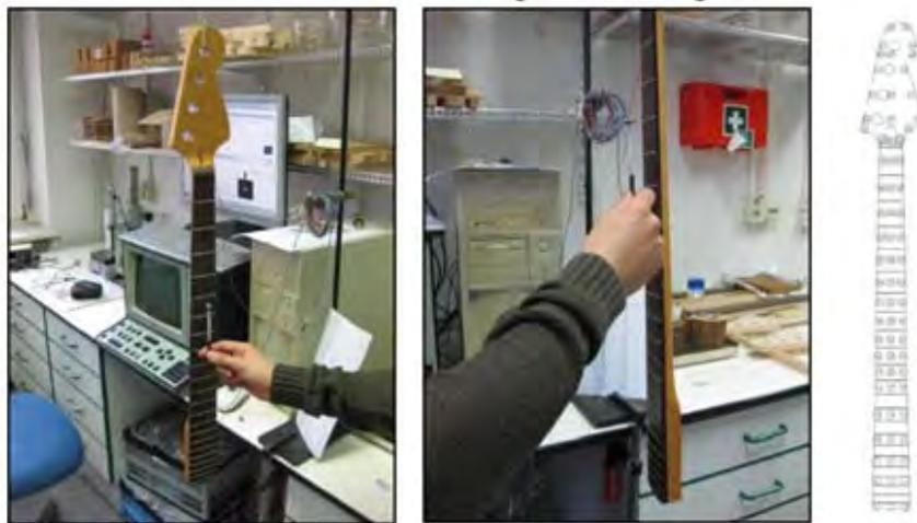
*Messaufbau und -anordnung zur Prüfung der Funktionsmuster (Bassgitarrenhülse) mithilfe der Modalanalyse*
