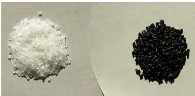
*Neue und mit Druckfarben angereicherte Polymere aus Laborversuchen.*
