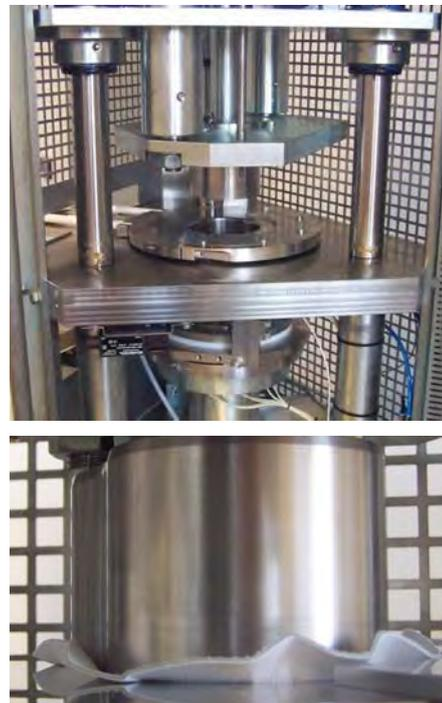
*Detailaufnahmen des Tiefziehversuchsstandes der Professur Verarbeitungsmaschinen/Verarbeitungstechnik*
