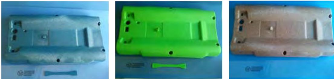
WPC Formteile aus Vorversuch zu Verarbeitungstest auf Industrieanlagen
