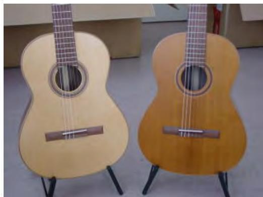
Instationäres Sorptionsverhalten von Fichte nativ und thermisch behandelt (Diagramm); Gitarrendecken aus nativer Fichte (links) und thermisch modifizierter Fichte (rechts)
