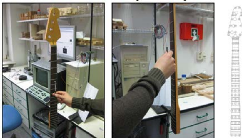
Messaufbau und -anordnung zur Prüfung der Funktionsmuster (Bassgitarrenhälsen) mithilfe der Modalanalyse (Unterstützung vom Institut für Festkörpermechanik der TU Dresden)
