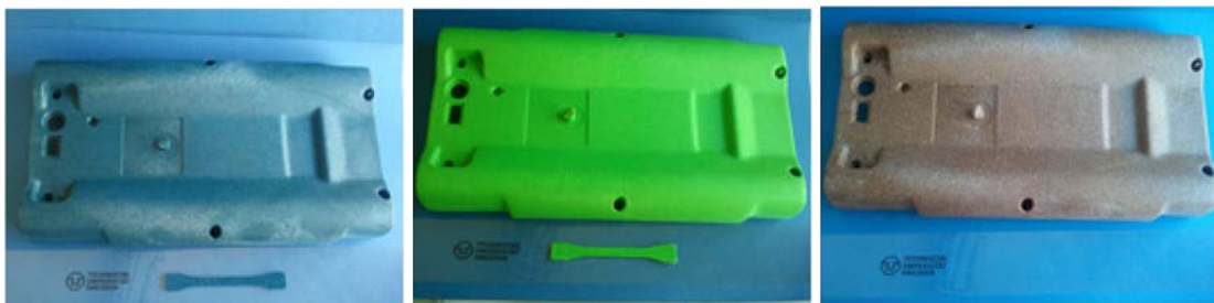
WPC Formteile aus Vorversuch zu Verarbeitungstest auf Industrieanlagen
