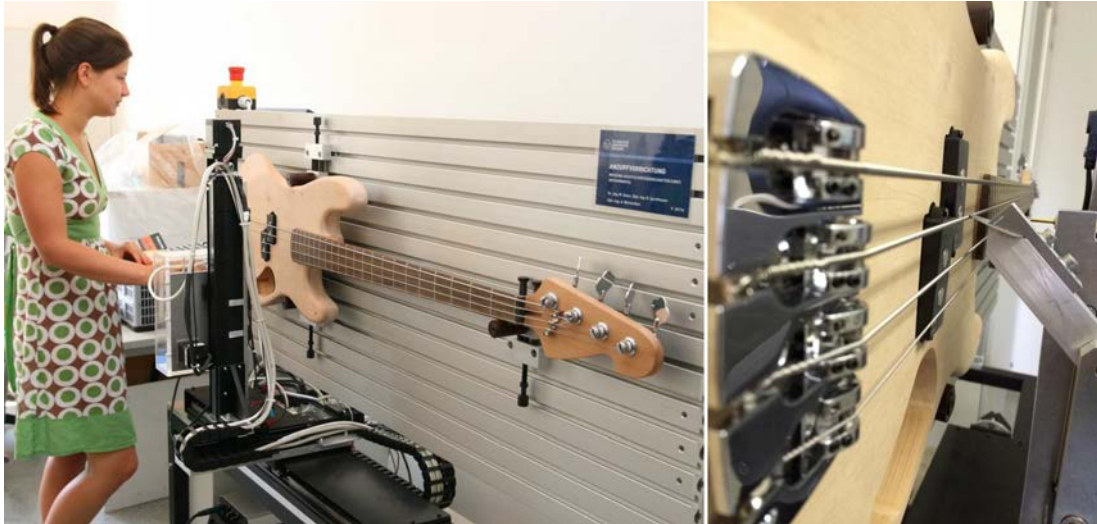
Ermittlung von Frequenzspektren eines ganzen Instrumentes (E-Bass) für die Auswertung des Einschwing- (Attack) und Ausklingverhaltens (Sustain) mithilfe einer eigens entwickelten automatischen Anzupfvorrichtung
