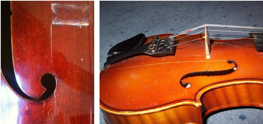
Deckenriss am F-Loch (li.) und nicht mehr zu reparierender Deckenriss (re.)
