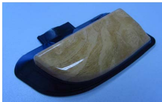
Furnier-Sensor-Verbund – Zwischenschritt Umformung (li.) und funktionalisierte Sichtblende mit Träger- und Deckschicht (re.)
