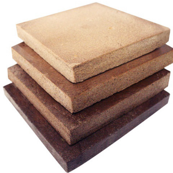
Plattenförmige, ligninbasierte Hartschäume
