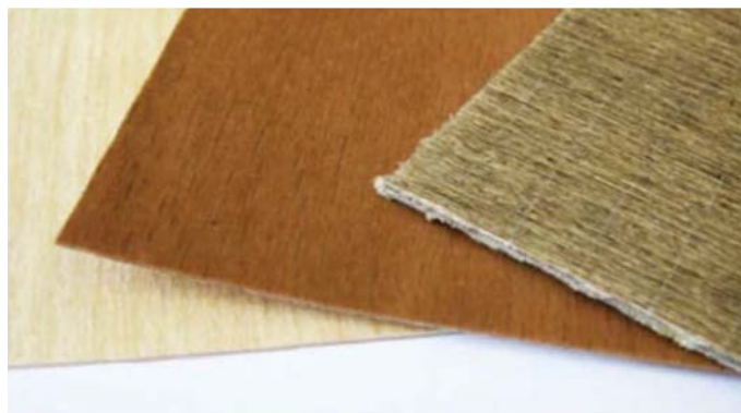
NFC-Prepregs aus Biopolymeren und Pappelholz, Buche oder Flachs (v. l. n. r.)
