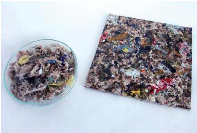
Trockene, teilweise aufbereitete Spuckstoffe (li.) und eine Zwischenstufe bei der stofflichen Nutzung (re.)
