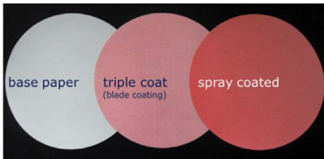
Beispiele für beschichtete Laborblätter (zur besseren Erkennbarkeit wurde die Beschichtung eingefärbt)
