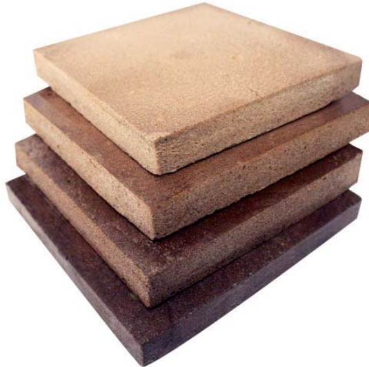
Plattenförmige, ligninbasierte Hartschäume
