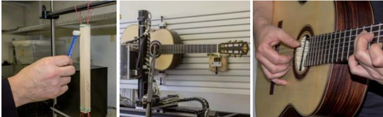
Modalanalyse an Prüfstäben (links), Anzupftest am gesamten Instrument (Mitte); Spieltest der Gitarre mit Musiker (rechts)
