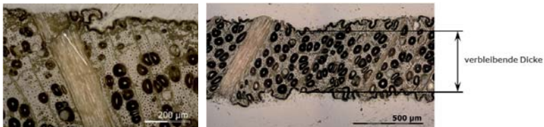
Riss im Furnier (links) und Ausbrüche an der Furnieroberfläche (rechts)
