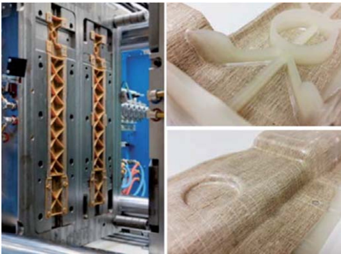
Kombiniertes Ur- und Umformen mit NFC-Organoblech
