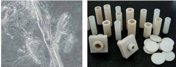
Entwicklung dreidimensionaler Formteile aus Cellulose (links: Cellulosefasersuspension; rechts: Formteile aus Cellulosefasern)
