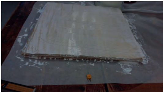
Erwärmtes und abgerakeltes Asset Powder
