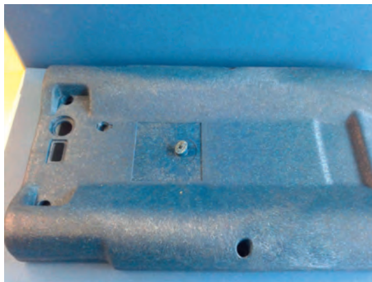
Farbschlieren auf der Oberfläche während der Verarbeitung
