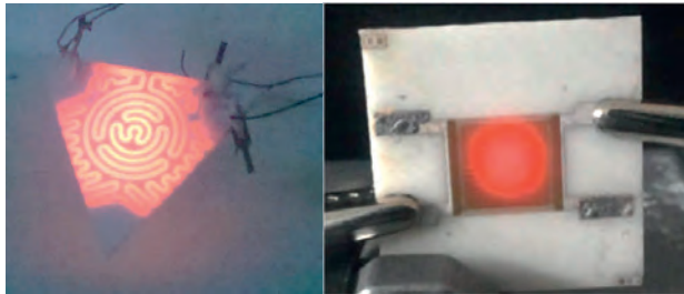
Links: Dreieckförmiger Strahlerheizer bei einer Temperatur von ca. 700 °C, Rechts: quadratischer Strahlerheizer bei einer Temperatur von ca. 600 °C
