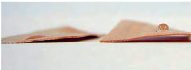
Chemische Furniermodifizierung zur Veränderung der Oberflächenbenetzbarkeit
