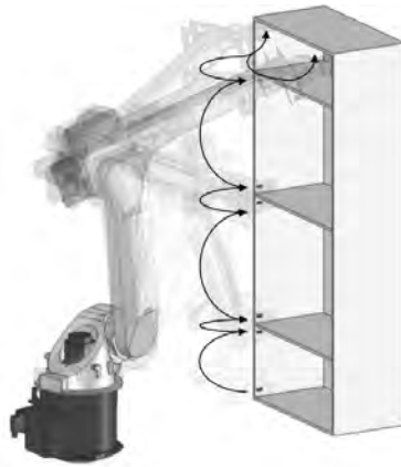
Mögliche Anordnung einer Roboterapplikation zum induktiven Beschlagkleben
