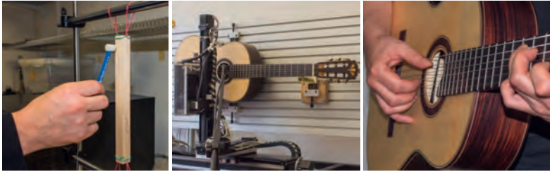
Modalanalyse an Prüfstäben (links), Anzupfstest am gesamten Instrument (Mitte); Spieltest der Gitarre mit Musiker (rechts)
