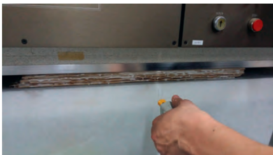
Fügen der Einzellagen zu einem mehrlagigen Halbzeug
