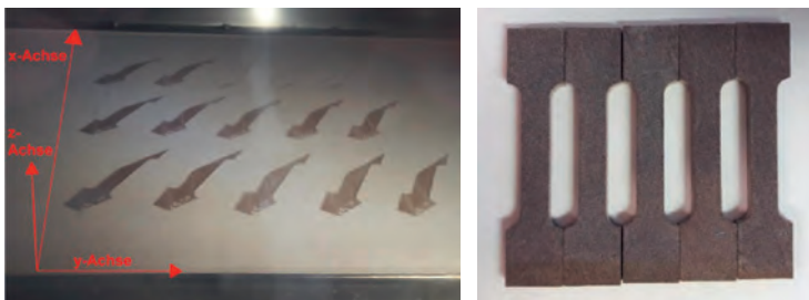
Herstellung der Prüfkörper im Sinterverfahren (li.) und fertige Prüfkörper (re.)
