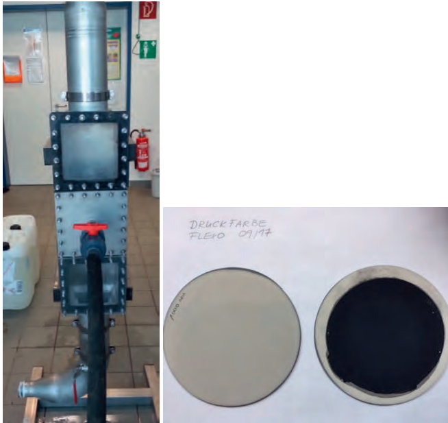
Links: Versuchsanlage zur Filtration des Kreislaufwassers, Rechts: Keramikfilter vor und nach der Filtration mit Farbrückständen.
