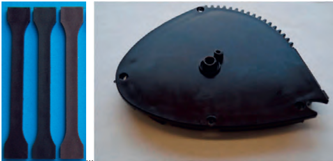
Prüfkörper und Funktionsmodell im Vakuumguss
