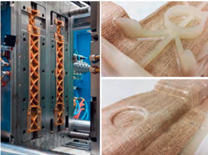
Kombiniertes Ur- und Umformen mit NFC-Organoblech
