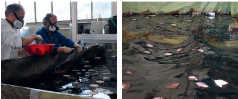
Ausbringen der funktionalisierten Binder im Wellenbecken der Univ. Rostock (links) und Schwimmtest mit Welle (rechts)
