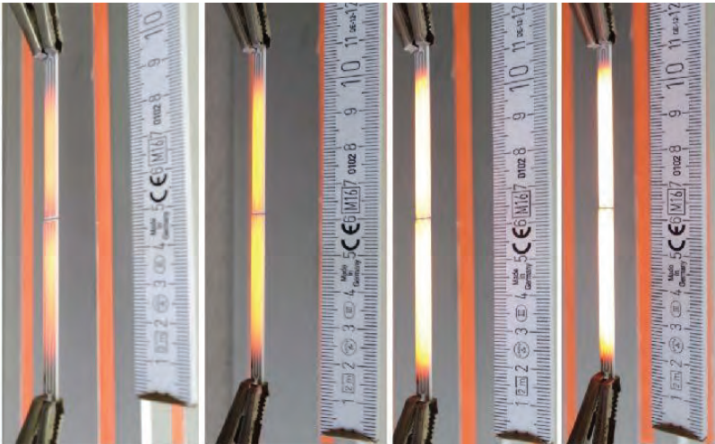
Glühende Teststrahler bei steigender, elektrischer Spannung und daraus resultierend einer höheren Temperatur (v.l.n.r.)
