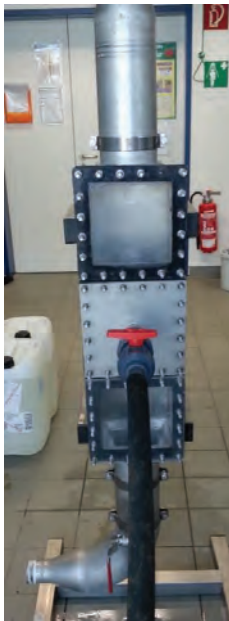
Links: Versuchsanlage zur Filtration des Kreislaufwassers, Rechts: Keramikfilter vor und nach der Filtration mit Farbrückständen. (Bilder: Fraunhofer IKTS Dresden)
