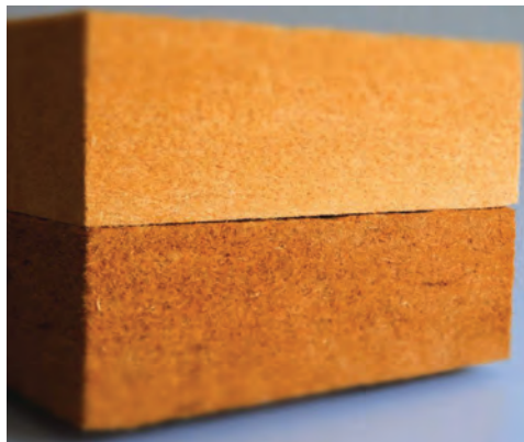
Dämmplatten aus Holzfasernstoff mit unterschiedlichen biopolymerbasierten Flammschutzmitteln (Foto: S. Tech)
