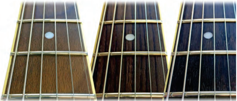
Testmuster, Griffbretter (v. l. n. r.): modifizierte Rotbuche (Fagus sylvatica L.), Palisander (Dalbergia latifolia Roxb.), modifizierte Eiche (Quercus robur L.)
