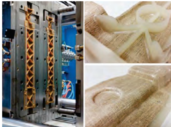
NFC-Prepregs aus Biopolymeren und Pappelholz, Buche oder Flachs (v. l. n. r.)
