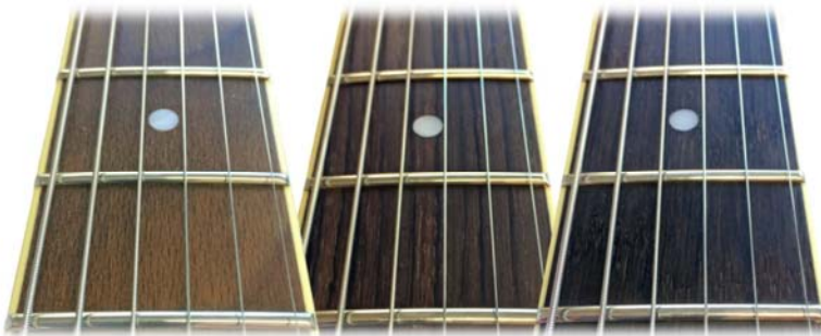
Testmuster, Griffbretter (v. l. n. r.): modifizierte Rotbuche ( Fagus sylvatica L.), Palisander ( Dalbergia latifolia Roxb.), modifizierte Eiche ( Quercus robur L.)
