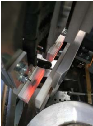
Links: In eine KAM eingebaute Strahlerbaugruppen mit jeweils fünf übereinanderliegenden Einzelstrahlern, Rechts: Darstellung des Schälmoments M als quantitative Vergleichsgröße für die Verbundfestigkeit von Referenzproben des konventionellen Schmelzklebstoffauftrags (HM), des Laserfügens, einer PU-Verklebung, des Nahinfrarot-Verfahrens und dem Entwicklungsstand des „Strahlungswärme-Fügens“ (SWF) mit den Holzwerkstoffen Spanplatte (PB) und Faserplatte (FB)
