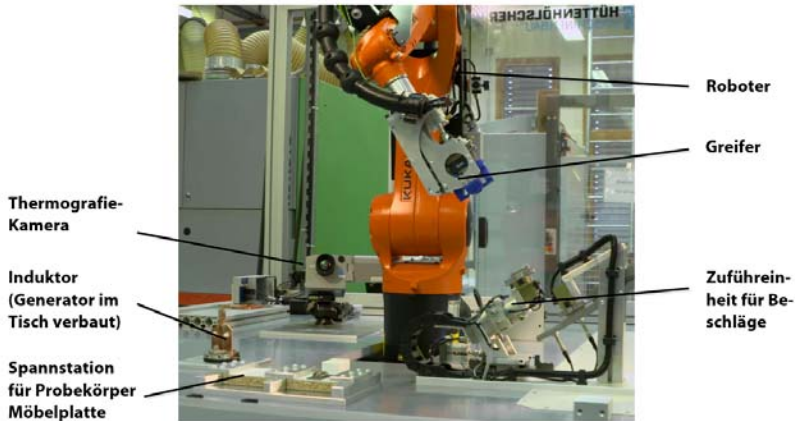
Ansicht der Roboterzelle mit Darstellung der Einzelbaugruppen
