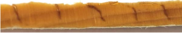
Risse infolge Furnierherstellung, Furnierdicke 3,3 mm, Risstiefe 70...80 % der Furnierdicke
