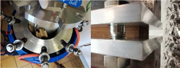
Autoklav zur Ammoniakinfiltration (links) und Pressplatten zur Verdichtung der plastifizierten Holzstruktur (rechts)
