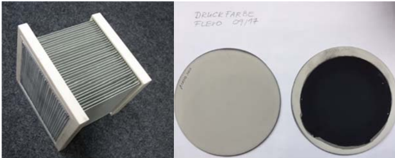
Links: Filterstack aus Mehrkanalelementen Rechts: Keramikfilter vor und nach der Filtration mit Farbrückständen. (Bilder: Fraunhofer IKTS Dresden)
