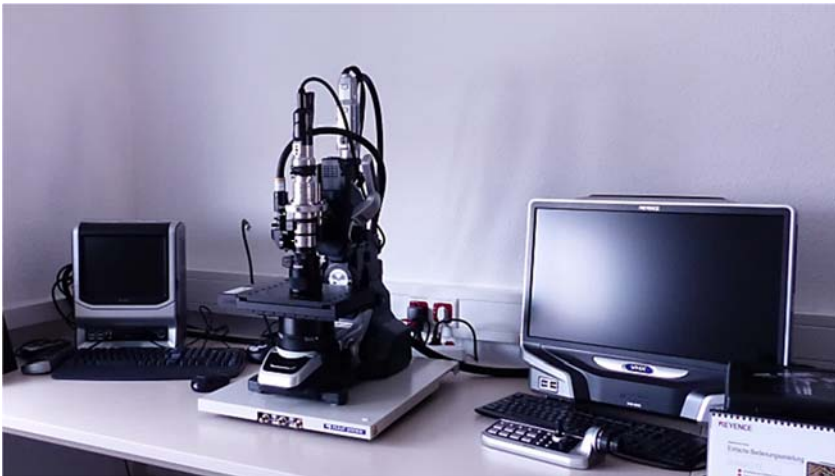
Mikroskoparbeitsplatz mit Keyence VHX 6000, inkl. Highspeed-Kamera VW-9000
