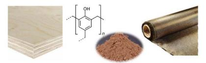
Holzfurnierwerkstoff, biobasiertes Phenolharz, Basaltfasertextil
