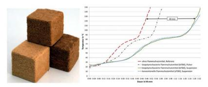
Dämmplatten – Temperaturverlauf im Schweltest (Foto: S. Tech)
