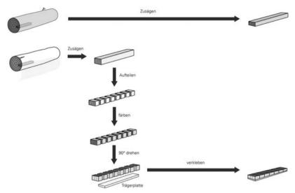
Schematischer Ablauf der Herstellung eines Gitarrengriffbretts mit Hirnholzoberfläche
