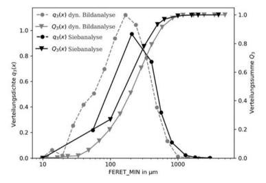
Ergebnisse der Partikelanalyse, Methodenvergleich zwischen dynamischer Bildanalyse und Siebanalyse, Massenverteilungsdichten und Massenverteilungssummen beider Methoden über der Partikelgröße x (Feret\_min) für eine identische Probe
