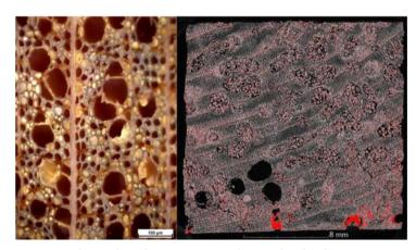
Links: verölte Holzmatrix im Querschnitt (Lichtmikroskopie) Rechts: verölte Holzmatrix (Röntgen-Mikrocomputertomografie)
