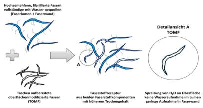
Faserstoffmischung mit trocken-oberflächenmodifizierten Fasern (TOMF) welche in das Faserstoffsystem eingebracht werden und als Füll- oder Armierungsfaser fungieren
