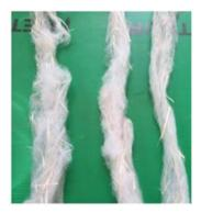
Vorversuche zur Thermoplast-Holzstruktur: Holzwolle und Polymer; Vlies; Band (v. l. n. r.)
