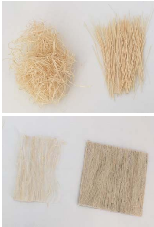
Industrielle Holz- wolle, Laborholz- wolle, textiles Halbzeug und Verbundplatte (v. o. l. n. u. r.)
