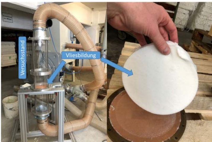
Versuchsstand zur Vliesstreuung (links) und gebildetes Vlies (rechts)
