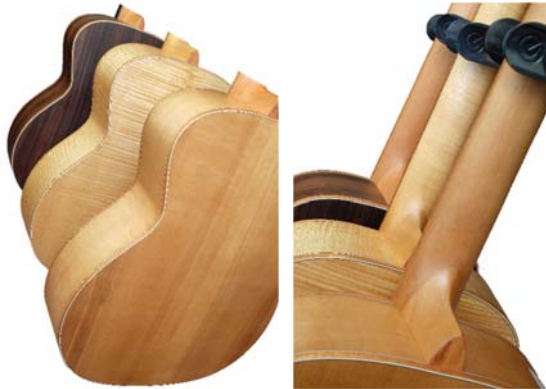
Gitarren mit Zargen (links) und Hälsen (rechts) aus einheimischen modifizierten Hölzern (hinten im Bild jeweils das Referenzmaterial)
