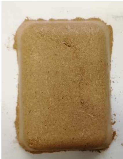
Werkzeug (oben) und Testformkörper (unten) aus Pilzrestsubstraten hergestellt ohne Ein- satz von Bindemitteln und Additiven
