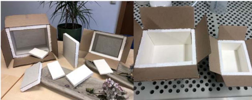
Funktionsmuster und Produktbeispiele aus den hergestellten Faserplatten
