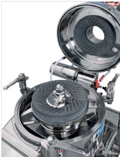
Blick in das geöffnete Mahlaggregat (Quelle: Produktbroschüre, FUCHS Maschinen AG)
