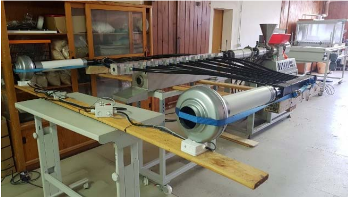
Entwickelter luftbasierter Extrusions-Formgebungsprozess in der Praxis
