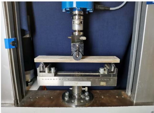
3-Punkt-Biegeprüfung eines Werkstoffverbundes aus Birkenholzfuernier und Basaltfasergewebe-verstärktem Phenolharz
