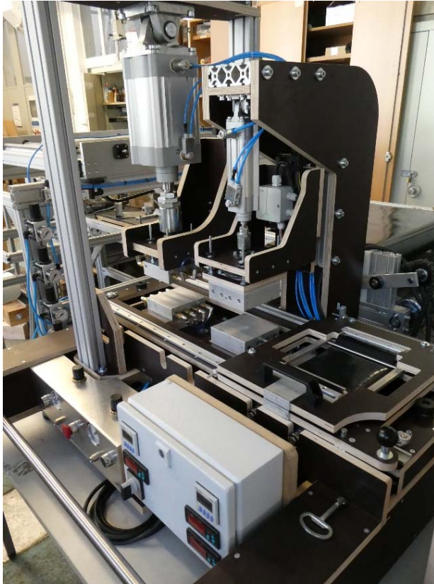
Versuchsstand zur Herstellung des Verbundaufbaus
