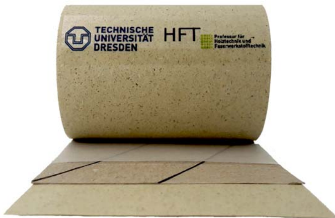
Prototyp BIOBOX: gewickelte Verpackung aus 100 % Papier, welche Nachhaltigkeit und Schutzfunktion vereint
