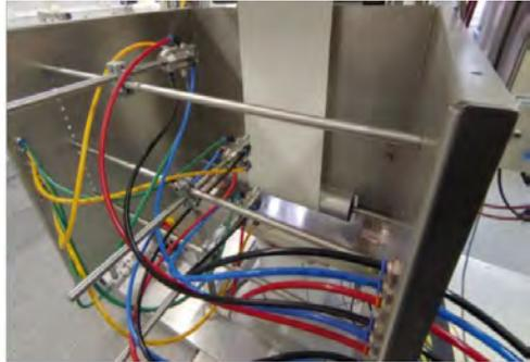
*Integration einer Sprüheinheit an der Laborstreichmaschine der AG Papiertechnik*
