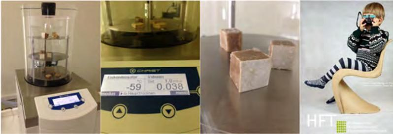
*Faserwerkstoffentwicklung zur Kunststoffsubstitution und Demonstrator (rechts)*
