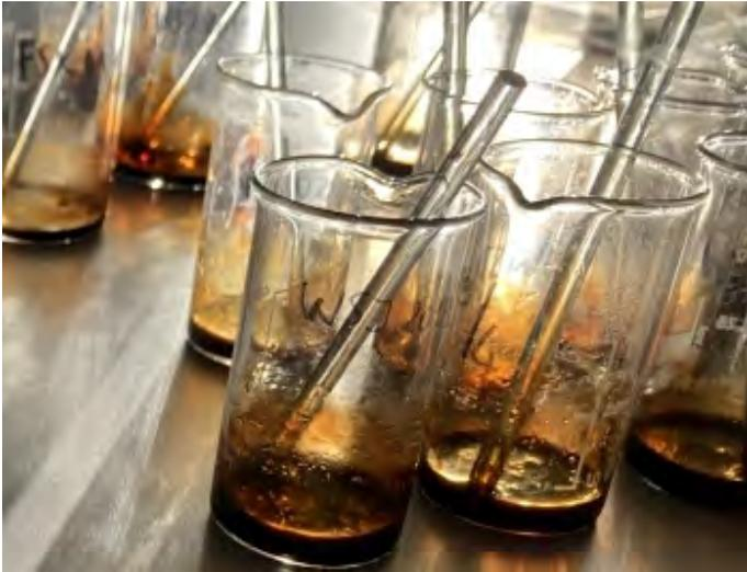
*Biobasierte Bindemittel- und Flammschutzformulierungen (Foto: S. Tech)*
