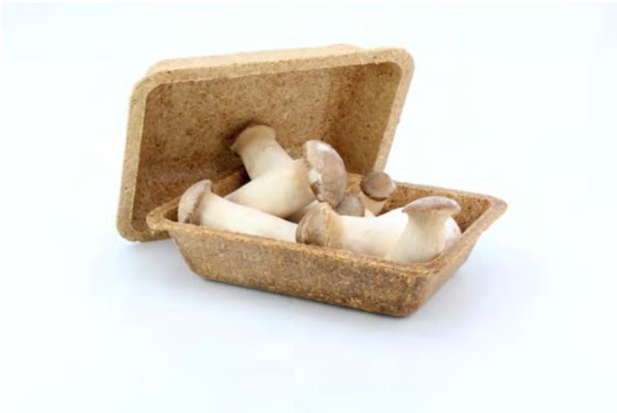
*Werkzeugdemonstrator (oben) und Verpackungsschale (unten) aus Pilzrestsubstraten hergestellt ohne Einsatz von Bindemitteln und Additiven*
