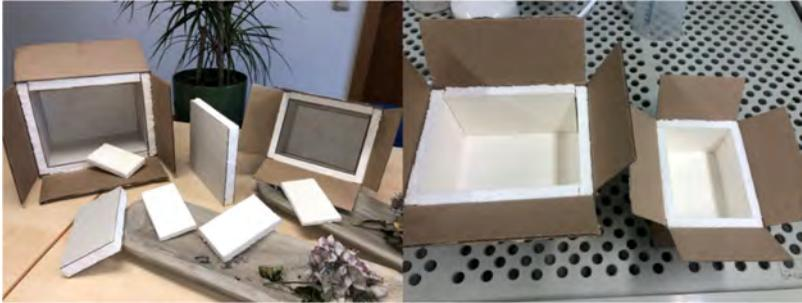
*Funktionsmuster und Produktbeispiele aus den hergestellten Faserplatten*
