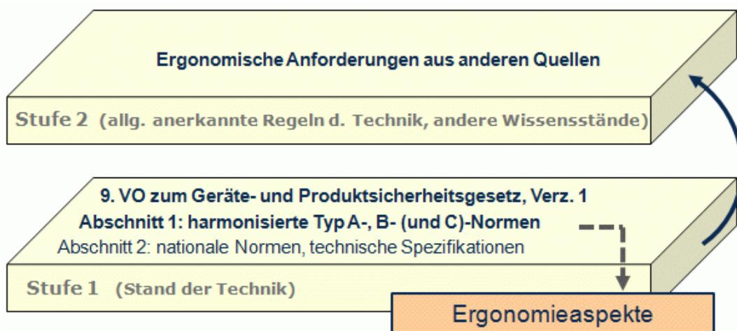
**Stufe 1** umfasst produktübergreifende ergonomierelevante Inhalte harmonisierter Typ A- und B-Normen (Grund- und Produktnormen), die den Stand der Technik wiedergeben. Sofern keine harmonisierten Normen vorliegen, können die als hilfreich und wichtig erachteten nationalen Normen und technischen Spezifikationen des Abschnitts 2 des Normenverzeichnisses genutzt werden.
