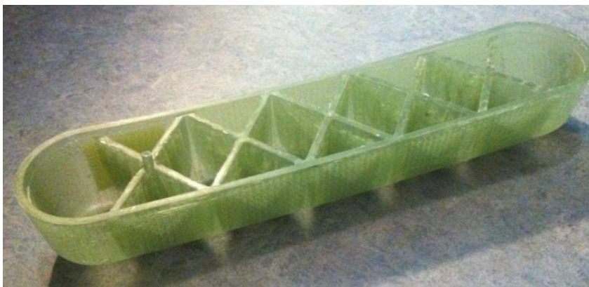
HTH-Leitdemonstrator mit rein duroplastischer Matrix
