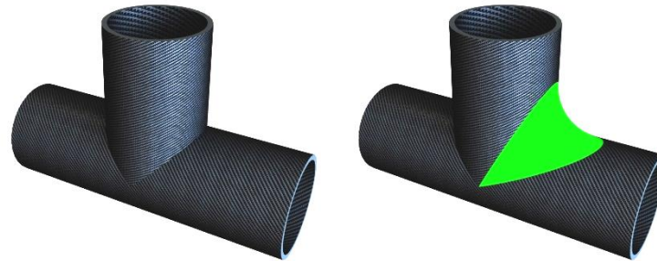
Abbildung 1: T-Knotenelement, links: klassisch, rechts: mit Verrundung (grün)
