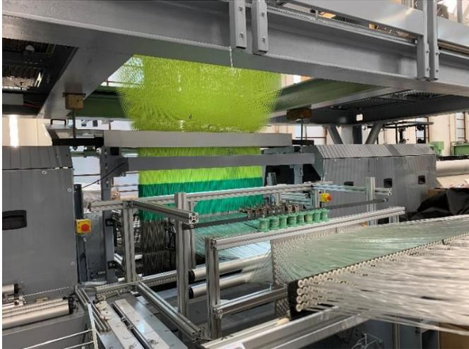
Abb. 1: Kettfadenzuführung der MAGEBA Steckschützenwebmaschine SL RTEC 1200/1 zur Herstellung der funktionalisierte Verstärkungsgewebe
