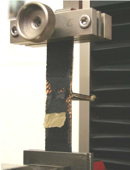
Abbildung 1: Bestimmung der Faser-Matrix-Haftung im Schälversuch
