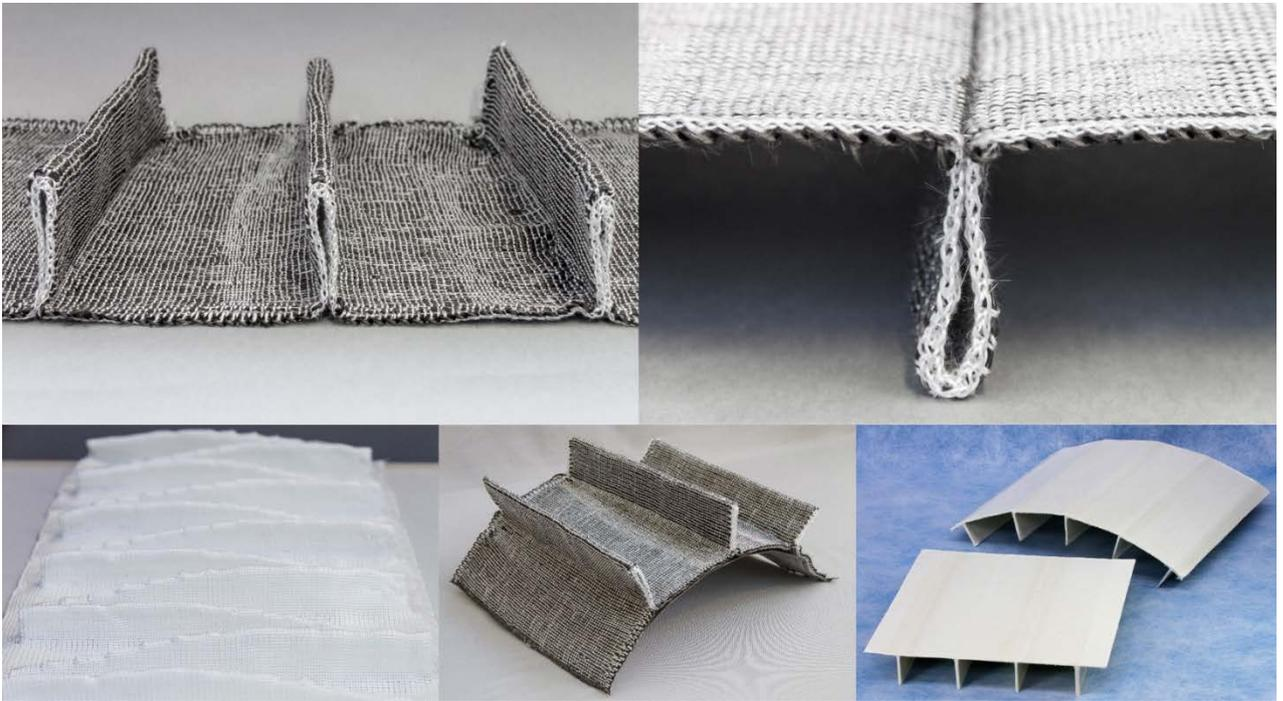
**Abbildung 1:** Integral gefertigte 3D-Schale-Rippen-MLG-Halbzeuge mit angepassten Schalen- bzw. Rippengeometrien und daraus herstellbare FKV-Bauteile mit Versteifungselementen © ITM
