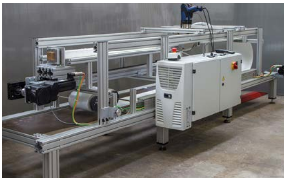
Abb. 1: Preforming-Versuchsstand im ITM-Technikum
