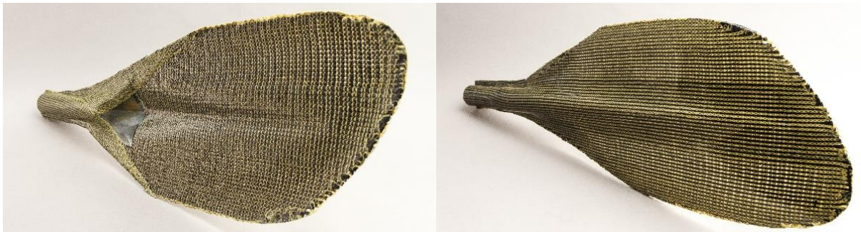
Abbildung 4 Demonstratorbauteil Paddel – Übergang von Schale (Paddelblatt) zu Profil (Paddelschaft)
