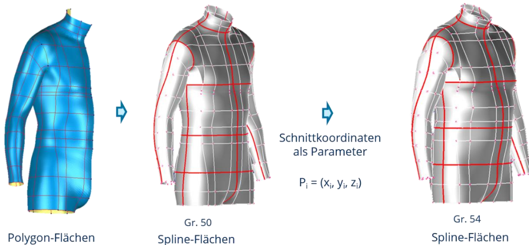
Abbildung 3: Generierung der parametrischen Formkörper, automatische Skalierung
