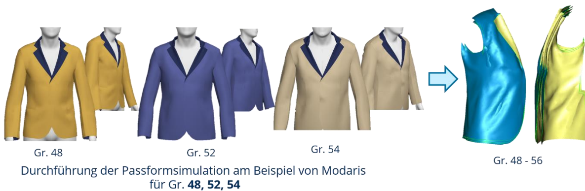
Abbildung 4: Ableitung der Geometrien für die Formwerkzeuge aus der Passformsimulation des Sakkos in Modaris (Lectra)
