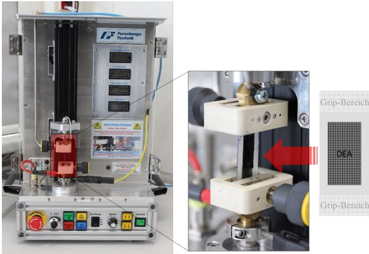
**Abbildung 5:** Smart Rubber Analyzer und vorgedehnter rechteckiger DEA auf PUR-Basis.
