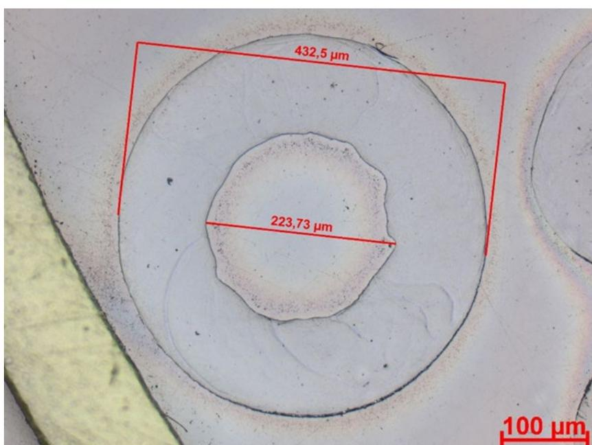
**Abbildung 10:** Mikroskopische Aufnahme eines TPU-Hohlfilaments nach Ablösung der PVA-Kernkomponente.
