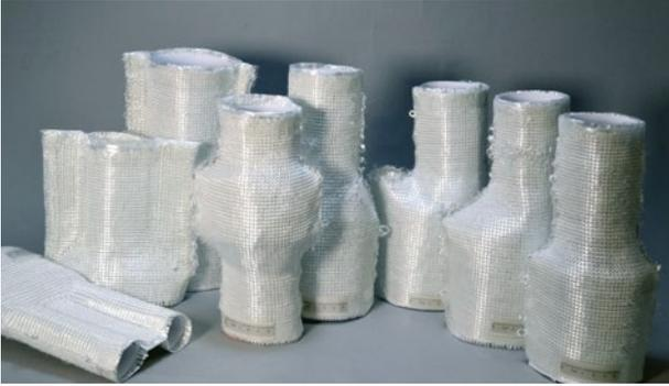
Abb. 2: Biaxial verstärkte MLG-Schlauchstrukturen mit variablem Durchmesser / *Biaxial-reinforced tubular weft-knitted fabrics with variable diameter in longitudinal direction*
