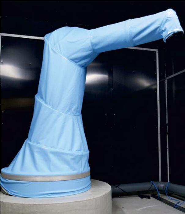
Abb. 14: Faltenfreie Roboterhülle im Einsatz / *Fold-free robot cover in use*
