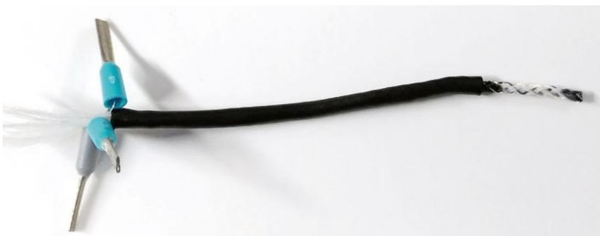
Geflochtener amperometrischer Laktatsensor mit Schutzhülle und Kontaktierung / Braided amperometric lactate sensor with protective sheath and contacting
