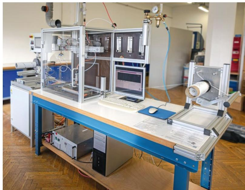
Plasmafackel für Oberflächenaktivierung und Beschichtung mit Abwickleinheit für garnförmige Proben und auch entsprechende Steuerung für flächige Behandlungen / Plasma jet for the activation of surface and sizing with winder for yarn-shaped samples and control for two-dimensional treatment
