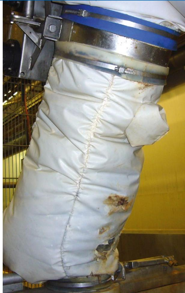
Abb. 2: Beschädigung an Roboterhülle mit Überdruck / Damaged air filled robot cover © iw
