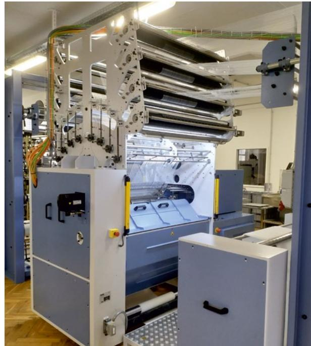
RR-Raschelmaschine zur Verarbeitung von groben Hochleistungsgarnen / *Double-bar raschel machine for the processing of coarse high-performance yarns*
