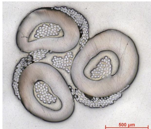
Schliffbild eines kapazitiven Sensorgeflechts mit vier garnförmigen Elektroden / Microscopic cross-section of a capacitive sensor braid with four conductive yarn electrodes
