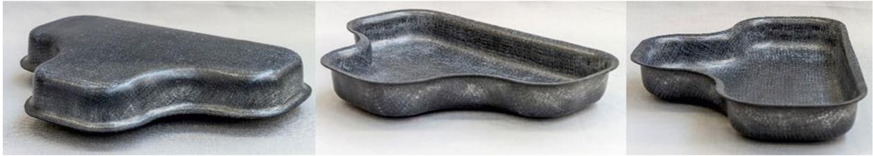
Abb. 10: 3D-rCFK Demonstratorbauteil „T-Napf“ / Realized 3D-rCFRP demonstrator “T-cup”
