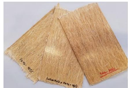
Bio-Thermoplastholzstrukturen und Bio-Composite / *Bio-thermoplastic wood structures and bio-composite*
