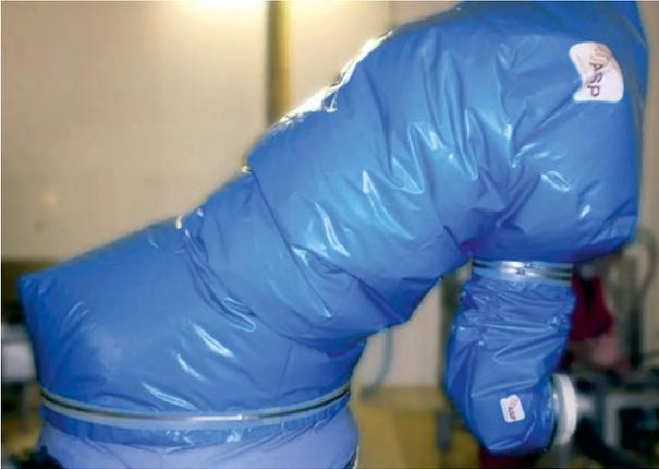
Abb. 1: Roboterhülle mit Überdruck / Air filled robot cover
