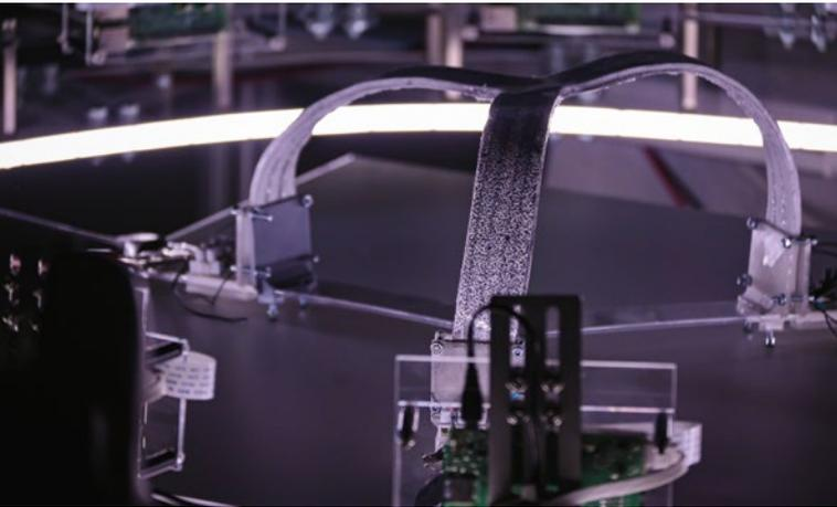
Weiche Robotikstruktur aus faserverstärktem Elastomer mit textilintegrierten Formgedächtnisaktoren / *Soft robotic structure made of fiber-reinforced elastomer with textile-integrated shape memory actuators*
