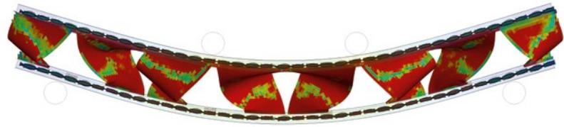
Simulation der Biegung eines Leichtbaupaneels mit webtechnisch integrierten gefalteten Papierbändern / *Bending simulation of a lightweight panel with weaving integrated paper tapes*
