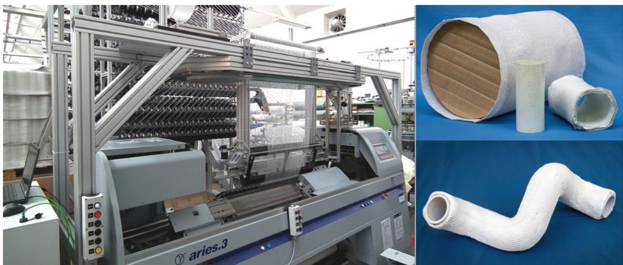
Abb. 1: Modifizierte Flachstrickmaschine Steiger ARIES.3 mit Schussfadenovalzuführung (li.) zur Fertigung von gestrickten 3D-Schlauchpreformen mit umlaufender Schussfadenverstärkung (re.) / Modified flat knitting machine Steiger ARIES.3 with oval warp yarn guide (left) for the weft-knitting of 3D tubular preforms with continuous weft reinforcement (right)
