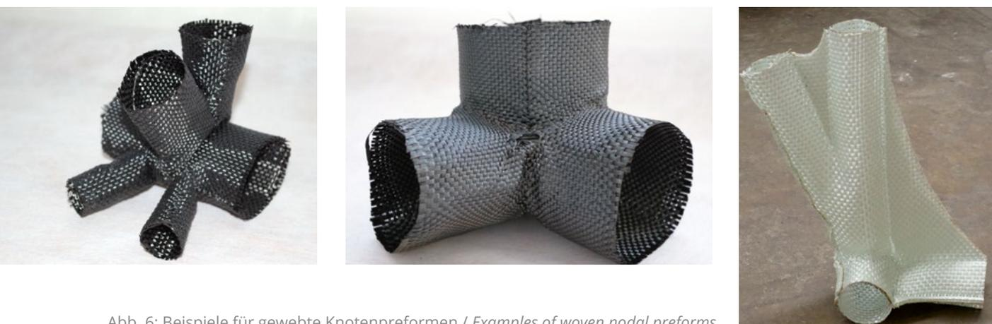
Abb. 6: Beispiele für gewebte Knotenpreformen / *Examples of woven nodal preforms*
