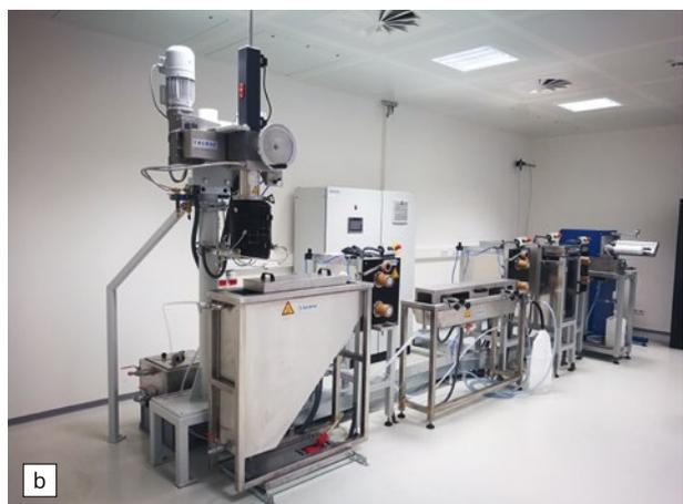
Abb. 3: Pilot-Lösungsmittel Nassspinnanlage (a) und Kolbenspinnanlage (b) des ITM / Solvent wet-spinning machine (a) and piston solvent spinning machine (b) of the ITM
