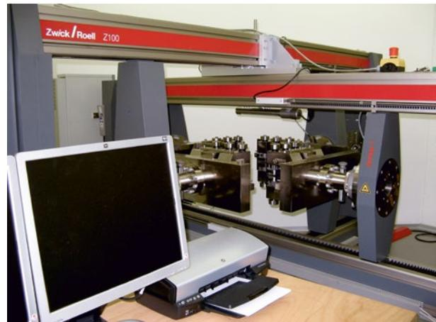
Abb. 4: Biaxialzugprüfmaschine / Biaxial tensile tester
