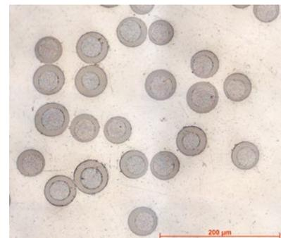
Abb. 5: Querschnitte von schmelzgesponnenen Biko-Fasern mit Kern-Mantel Geometrie aus PP und PVDF / Cross-sectional images of melt-spun core-sheath type bico fibers made from PP and PVDF
