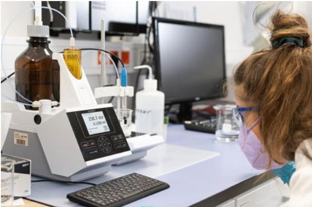
Säure-Base-Titrator TitroLine® 7000
