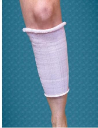
Abb. 3: Exemplarischer Wadenstrumpf aus Gestrick mit Formgedächtniseffekt / *Exemplary knitted calf sock with shape memory effect*
