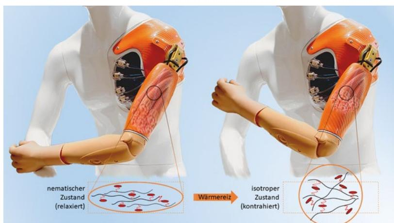
Prinzip der flüssigkristallinen Elastomerfasern als Muskeln / *Principle of the liquid-crystalline elastomer fibers as muscles*
