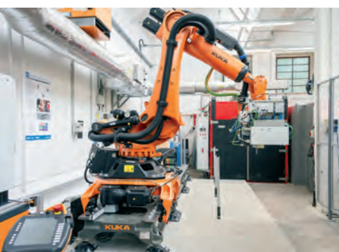
Robotergestützte Fertigung textiler Hochleistungsstrukturen (links), textile Bewehrungsstruktur (Mitte), Greiferelement (rechts) / Robot-based production of high-performance textile structures (left), reinforcement structure (middle), gripper element (right)
