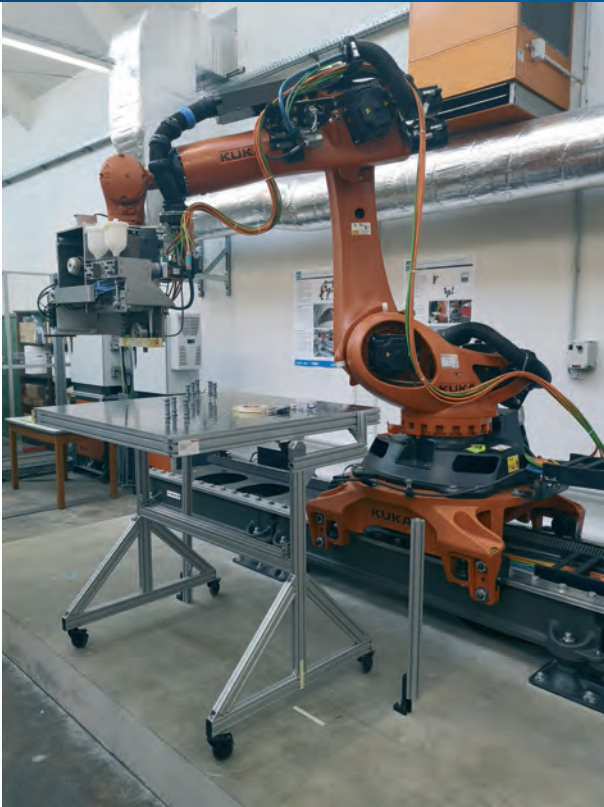
Abb. 1: Umgesetztes Anlagensystem in Integralbauweise; links: Ansicht des Gesamtaufbaus; rechts: Detailansicht des Legekopfs mit Abspul-, Dosier- und Tränkeinheit / Converted plant system in integral design; left: View of the overall construction; right: Detailed view of the laying head with unwinding, dosing and feeding unit
