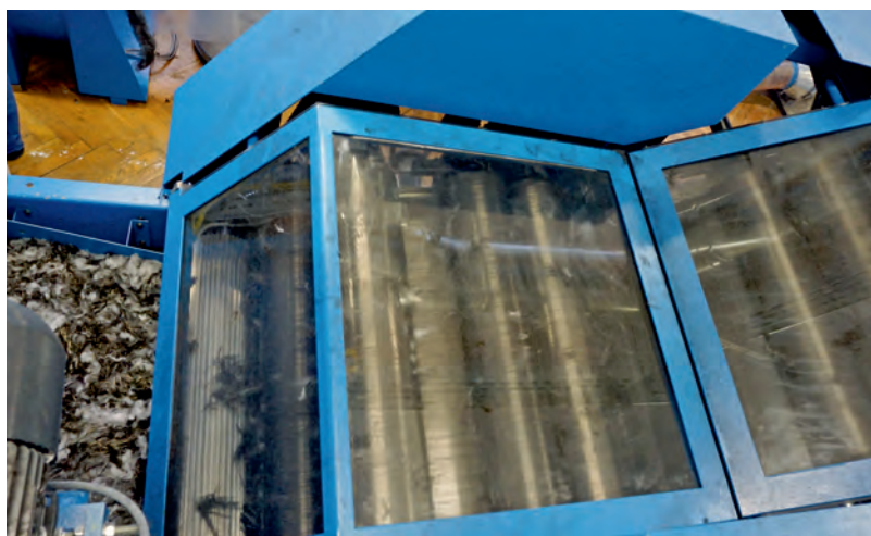
Abb. 2: Dilo-Speziallaborkrempelanlage mit Bandbildungsvorrichtung / Special laboratory carding machine with sliver formation unit
