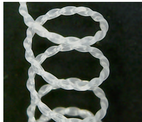
Aufnahme eines hochverdrehen, verzwirnten und gewickelten thermisch aktivierbaren Monofilaments und ein umflochtener Formgedächtnisdraht mit Polyamid-Kupfer-Mantel zur Temperaturüberwachung während der Aktivierung / Highly twisted, plied and wound thermally active monofilament and a shape memory wire with a braided sheath of polyamide and copper for temperature control during activation
