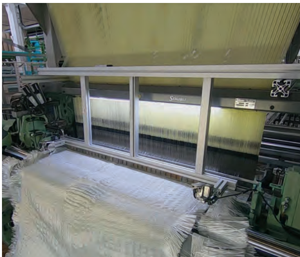
Greiferwebmaschine PTS 4/J (mit entwickeltem Schussfadenrückhaltesystem) (Lindauer DORNIER GmbH) / PTS 4/J rapier weaving machine (with developed weft hold-back system)
