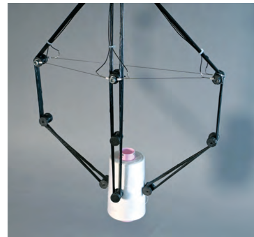
Abb. 2: Roboter-gestützt hergestellter CFK-Leichtbaugreifer mit integrierter Aktorik auf Basis von Formgedächtnislegierungen (rechts) sowie simulations-gestützte Parametervariation (links) / Robot-manufactured CFRP lightweight gripper with integrated actuators based on shape memory alloys (right) and simulation-supported parameter variation (left)
