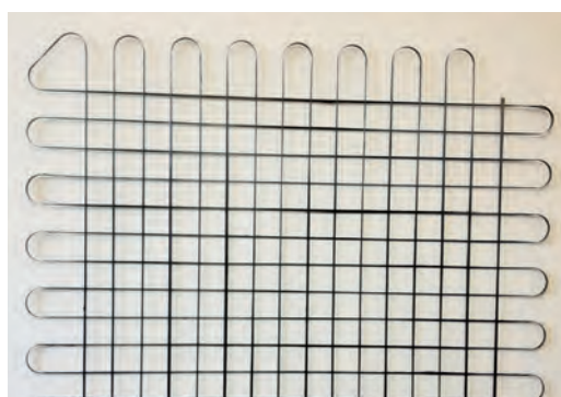
Robotergestützte Fertigung textiler Hochleistungsstrukturen (links), textile Bewehrungsstruktur (Mitte), Greiferelement (rechts) / Robot-based production of high-performance textile structures (left), reinforcement structure (middle), gripper element (right)
