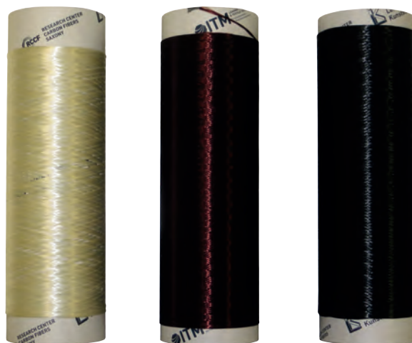
Abb. 4: PAN- (links), teilstabilisierte RCCFox- (Mitte) und Carbonfaser (rechts) / PAN- (left), partly stabilized RCCFox- (middle) and carbon fiber (right)
