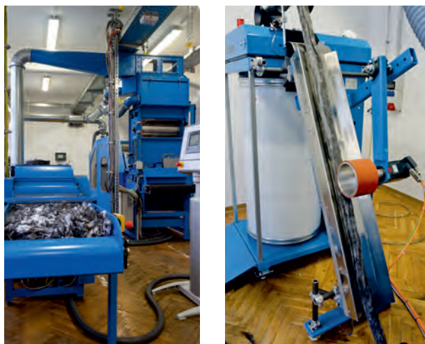
Abb. 2: Dilo-Speziallaborkrempelanlage mit Bandbildungsvorrichtung / Special laboratory carding machine with sliver formation unit
