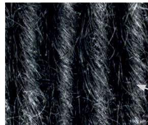
Leitfähige Hybridgarnkonstruktion aus Stahldraht und GF / Conductive hybrid yarns made of steel and GF
