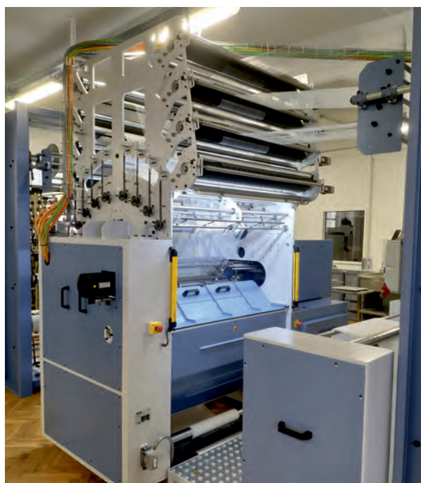
RR-Raschelmaschine zur Verarbeitung von groben Hochleistungsgarnen / Double-bar raschel machine for the processing of coarse high-performance yarns
