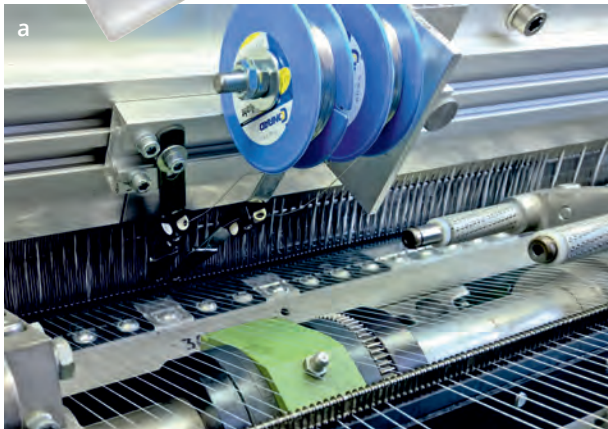
Einbindung von Funktionsfäden beim Wirken (a), PKW-Heckklappe mit textilintegriertem Bremslicht und Tastsensor (b), multifunktionale Bewehrungsstruktur zur Verstärkung und kontinuierlichen Bauwerksüberwachung (c) / Integration of functional yarns during the warp knitting (a), Vehicle tailgate with installed LED brake lights and tactile sensor (b), multifunctional reinforcement structure for continuous building monitoring (c)
