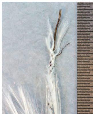
Aufnahme eines hochverdrehen, verzwirnten und gewickelten thermisch aktivierbaren Monofilaments und ein umflochtener Formgedächtnisdraht mit Polyamid-Kupfer-Mantel zur Temperaturüberwachung während der Aktivierung / Highly twisted, plied and wound thermally active monofilament and a shape memory wire with a braided sheath of polyamide and copper for temperature control during activation
