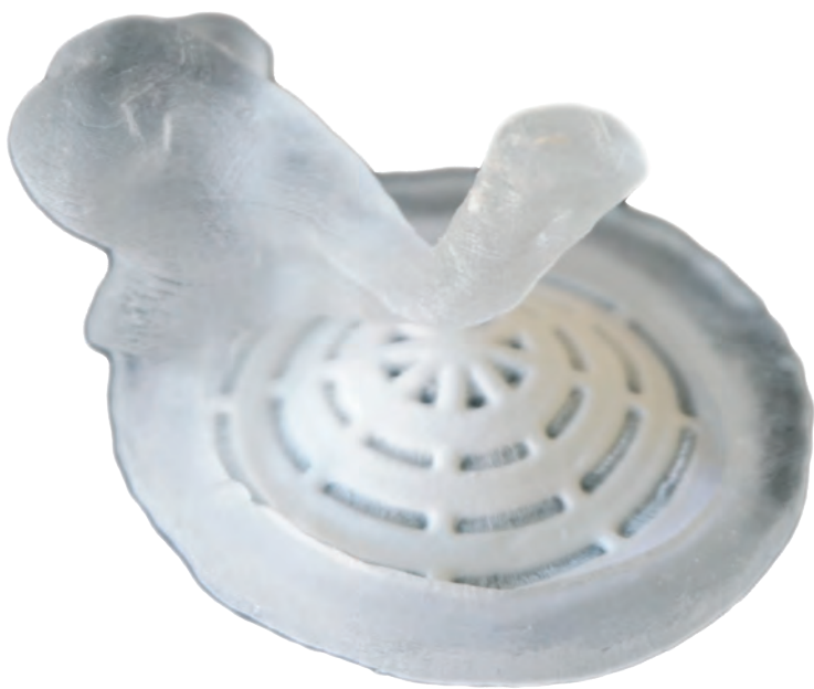
Abb. 7: (a) Gradierte biomimetische Ersatzmembran mit orientierten Faserbereichen in einem Gehörknöchelchenmodell; (b) Rasterelektronenmikroskopische Aufnahme einer beispielhaften bimodalen Faserdurchmesser-Verteilung in einer biomimetischen Ersatzmembran / (a) Graded 3D tympanic membrane replacement with oriented fiber segments in an ossicular chain model ; (b) Scanning electron microscopy image of an exemplary bimodal fiber diameter distribution in SF-PCL-membranes
