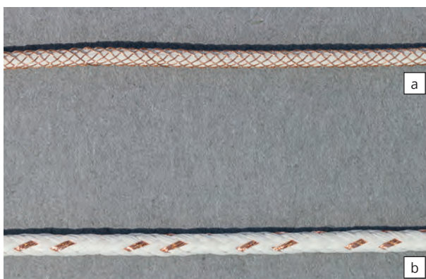
Piezoelektrische Sensorgarne: (a) TriKomponenten (TriKo)-Koaxial-Garn; (b) mit helixförmiger Elektrodenstruktur; (c) Schliffkörperbild des TriKo-Garns mit Kupferfilamenten als Innen- und Außenelektrode sowie schmelzgesponnene PA6-PZT-Multifilamente als Piezoelektrikum / Piezoelectric sensor yarns: (a) tricomponent (trico) coaxial yarn; (b) with helical electrode structure; (c) microscopic view of trico yarn with copper filaments as inner and outer electrodes and melt-spun PA6-PZT multifilaments as piezoelectricum
