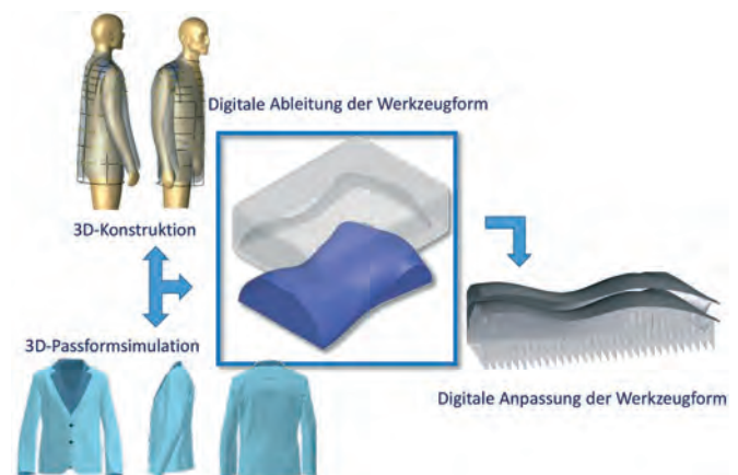
Abb. 1: Digitale Prozesskette zur Ableitung der Bügelwerkzeuge / Digital process chain for deriving the ironing tools
