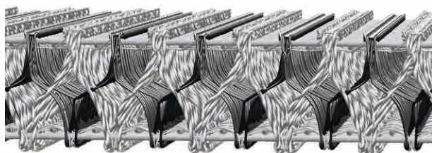
3D-Modelle von thermoelektrischen abstandsgewirkten Paneelen / 3D-models for thermoelectric spacer warp knitted panels
