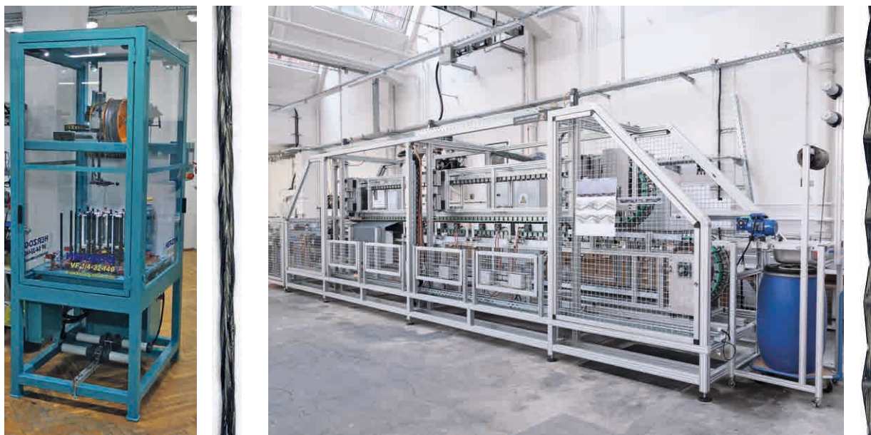
Abb. 1: Darstellung des Variationsflechters zur Fertigung der Variationsgeflechtstrukturen (links) sowie der Laboranlage zur Fertigung von tetraederförmigen Profilgarnen (rechts) / Depiction of a vario braiding machine for the fabrication of vario braiding structures (left) and the laboratory unit for the fabrication of tetrahedral profiled rovings (right)
