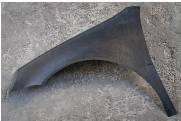
Textiles Biaxialgelege mit konturgerechten Verstärkungsschussfäden für PKW-Kotflügel (oben), konsolidierter Demonstrator, PKW-Kotflügel (unten) / Textile biaxial NCF with contour reinforcing weft yarns for car fenders (top), consolidated demonstrator, car fender (bottom)
