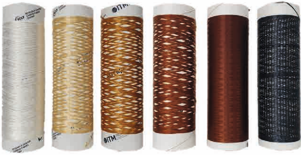
Abb. 3: Am RCCF hergestellte Spulen von der PAN-Präkursorfaser über mehrere Stabilisierungsstufen bis hin zur Kohlenstofffaser (von links nach rechts) und Kohlenstofffasern eingebettet in Beton (rechts) / Spools of PAN precursor fibre over several stabilizing steps to carbon fibre (from left to right) and carbon fibre embedded in concrete (right)
