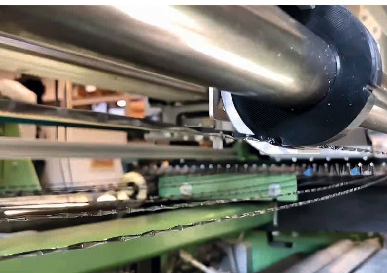
Abb. 4: Stabablage für automatisierten Schusseintrag von Profilmanteln / Rod placement system for automatic weft insertion of profiled yarns
