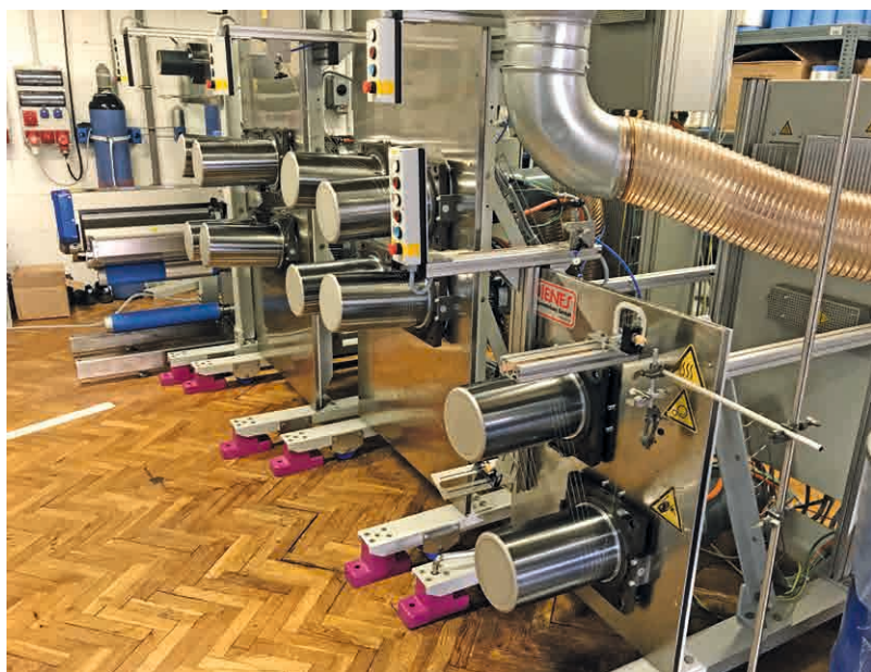
Abb. 2: Schmelzspinnentechnik mit modularer Bikomponentenschmelzspinnanlage (Fa. Dienes Apparatebau GmbH) / Melt spinning pilot line with modular bicomponent melt spinning plant (Dienes Apparatebau GmbH)
