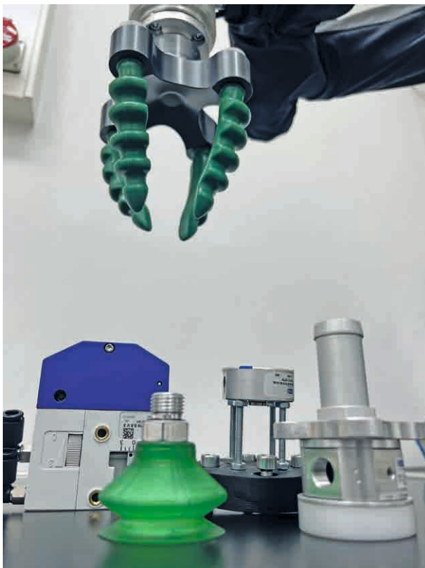
Abb. 2: Auswahl der Greifer für textile Materialien der Firma Schmalz GmbH / Selection of grippers for textile materials by Schmalz GmbH
