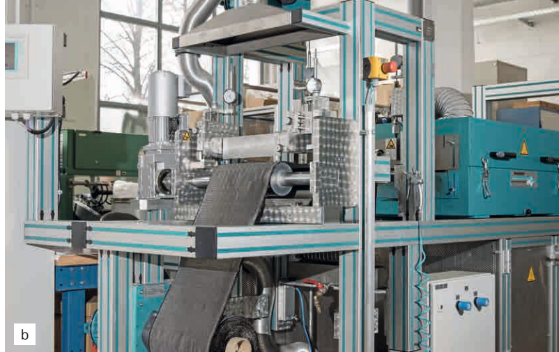
Abb. 2: Labor-Foulard mit entsprechender Trocken- und Fixiereinheit von Werner Mathis AG (a), modularer Basecoater (b) und multifunktionelle Beschichtungsanlage von Coatema Coating Machinery GmbH (c) / Laboratory foulard and corresponding drying and fixation plant from Werner Mathis AG (a), modular Basecoater (b) and multi-functional coating plant from Coatema Coating Machinery GmbH (c)
