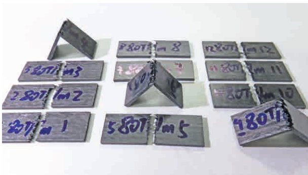
Geprüfte Proben mittels Charpy-Pendelschlagwerk / Tested specimens by charpy impact tester
