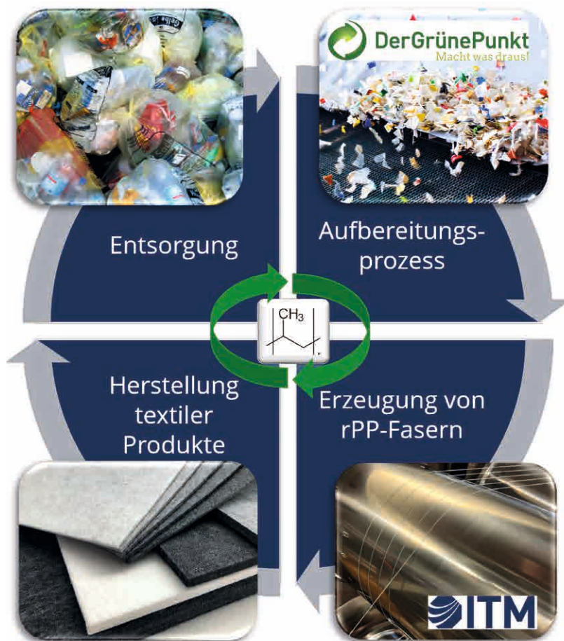
Abb. 1: Verfahrenskonzept zur Herstellung von recycelten Polypropylenfasern aus post consumer Abfällen / Concept for the production of recycled polypropylene fibers from post consumer waste
