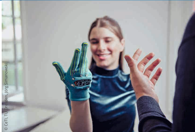
Abb. 4: Stricktechnisch mit Knit-&Wear® bzw. WholeGarment® realisierte E-Textiles mit integrierten textilbasierten Bewegungssensoren und textilen Leiterplatten / Weft-knitted e-textiles with integrated textile-based motion sensors and textile circuit boards realized with Knit-&Wear® and WholeGarment® technology
