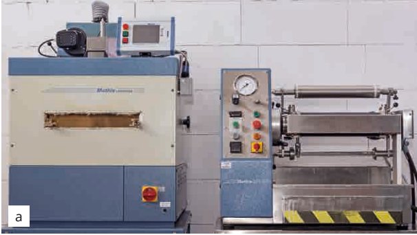
Abb. 2: Labor-Foulard mit entsprechender Trocken- und Fixiereinheit von Werner Mathis AG (a), modularer Basecoater (b) und multifunktionelle Beschichtungsanlage von Coatema Coating Machinery GmbH (c) / Laboratory foulard and corresponding drying and fixation plant from Werner Mathis AG (a), modular Basecoater (b) and multi-functional coating plant from Coatema Coating Machinery GmbH (c)
