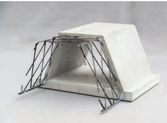
Carbonbetondemonstratoren: Netzgitterträger (links), Wandmodul (Mitte), Amphibienschutzleitwand (rechts) / Carbon concrete demonstrators: Mesh girder (left), wall modul (middle), amphibian protection baffle (right)
