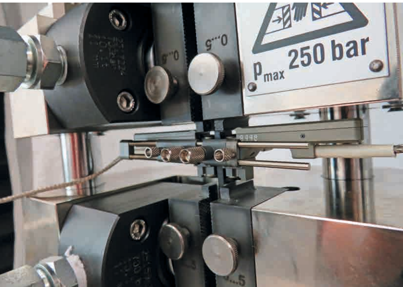
HCCF-Spannwerkzeug mit MF-Aufnehmer / Hydraulic compression test kit for composites (HCCF) with digital clip-on extensometer
