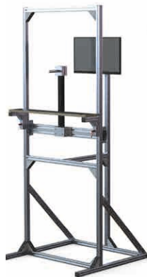
Interaktiver Demonstrator zur Zug- und Druckmessung durch Krafteinwirkung auf ein sensorisch funktionalisiertes CFRP U-Profil / Interactive demonstrator for tension and pressure measurement through the application of force on a sensor functionalised CFRP U-profile
