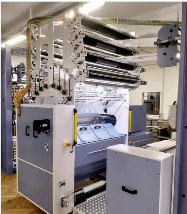
RR-Raschelmaschine zur Herstellung von Abstands- und Schlauchgewirken / Double-bar raschel machine for the production of spacer and tubular warp knitted fabrics
