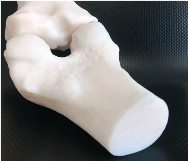
Kniegelenk-Formkörper zur Prüfung von textilen Bänder- und Sehnenimplantaten / 3D printed knee joint for testing textile ligament and tendon implants
