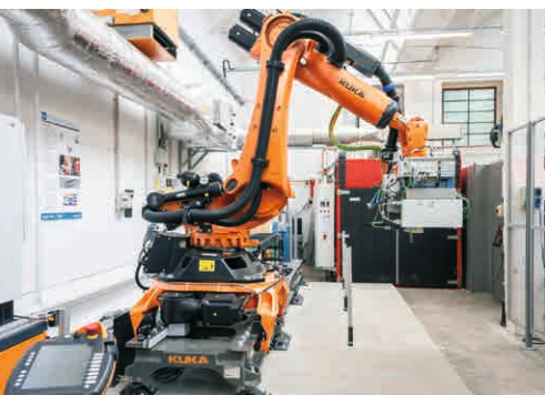
Robotergestützte Fertigung textiler Hochleistungsstrukturen (links), 3D-Bewehrungsstruktur (Mitte), Greiferelement (rechts) / Robot-based production of high-performance textile structures (left), 3D-reinforcement structure (middle), gripper element (right)
