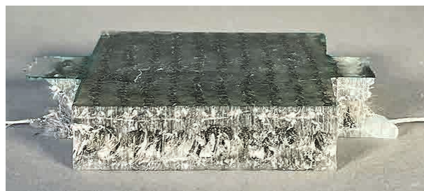
Schnittansicht eines thermoelektrischen abstandsgewirkten Paneels / Cross section of a thermoelectric warp knitted spacer fabric
