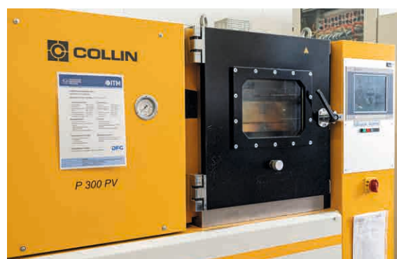
Abb. 1: 2K-Misch- und Dosieranlage Tartler NODOPUR VS für Harzinfusionen im RTM- und VARI-Verfahren (li.) und hydraulische Heißpresse Dr. Collin 300 PV für die Herstellung thermoplastischer FKV (re.) / 2K mixing and metering system Tartler NODOPUR VS for resin infusion in RTM and VARI processes (left) and hydraulic hot press Dr. Collin 300 PV for the production of thermoplastic FRP (right)
