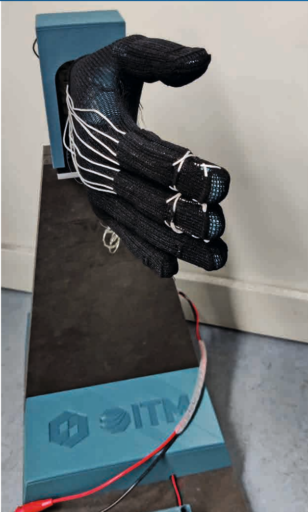
Aktor-Handschuh: Formgedächtnisbasiert für Force-Feedback-Anwendungen / Actuator glove: Shape-memory-based for force feedback applications
