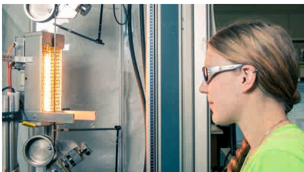
Hochtemperaturprüfstand an Garnen/Rovings / High temperature test stand for yarns/rovings
