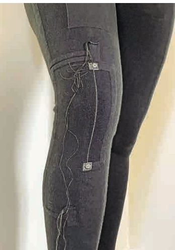
Abb. 1: Gestrickte Funktionsleggings mit integrierten textilbasierten Dehnungssensoren für die Ganganalyse mit einem körpernahtragbaren System zur funktionellen Elektrostimulation bei Patienten mit Mobilitätsbeeinträchtigungen durch Multiple Sklerose / Weft-knitted functional leggings with integrated textile-based strain sensors for gait analysis with a body-worn system for functional electrostimulation (FES) for patients with mobility impairments due to multiple sclerosis
