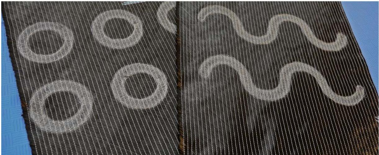
Die Kleberauswahl ist hier von entscheidender Bedeutung: Er muss noch während des Legeprozesses abbinden und darf bei nachfolgenden Prozessschritten keinen Einfluss auf die Eigenschaften des Fertigproduktes nehmen. Der so fixierte Lagenverbund wird automatisch in das Schneidbett des Cutters gefördert und dort mit Vakuum kompaktiert und mit einem Spezialmesser, das besonders für den Zuschnitt von Kohlefasern geeignet ist, zugeschnitten.
