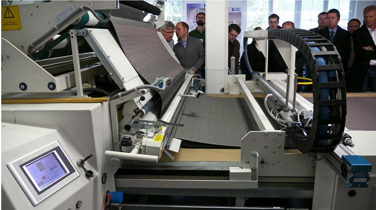
Parallel zu dem Legeprozess verfährt eine Koordinatenbrücke den Sprühkopf (Mehrfachdüsen) entsprechend dem Klebstoffsprühauftrag zu den Fixierstellen. Durch eine hochkomplexe Steuerung über Luftdüsen, können die Kleberfäden je nach Bedarf und Klebeanforderung abgelenkt werden.
