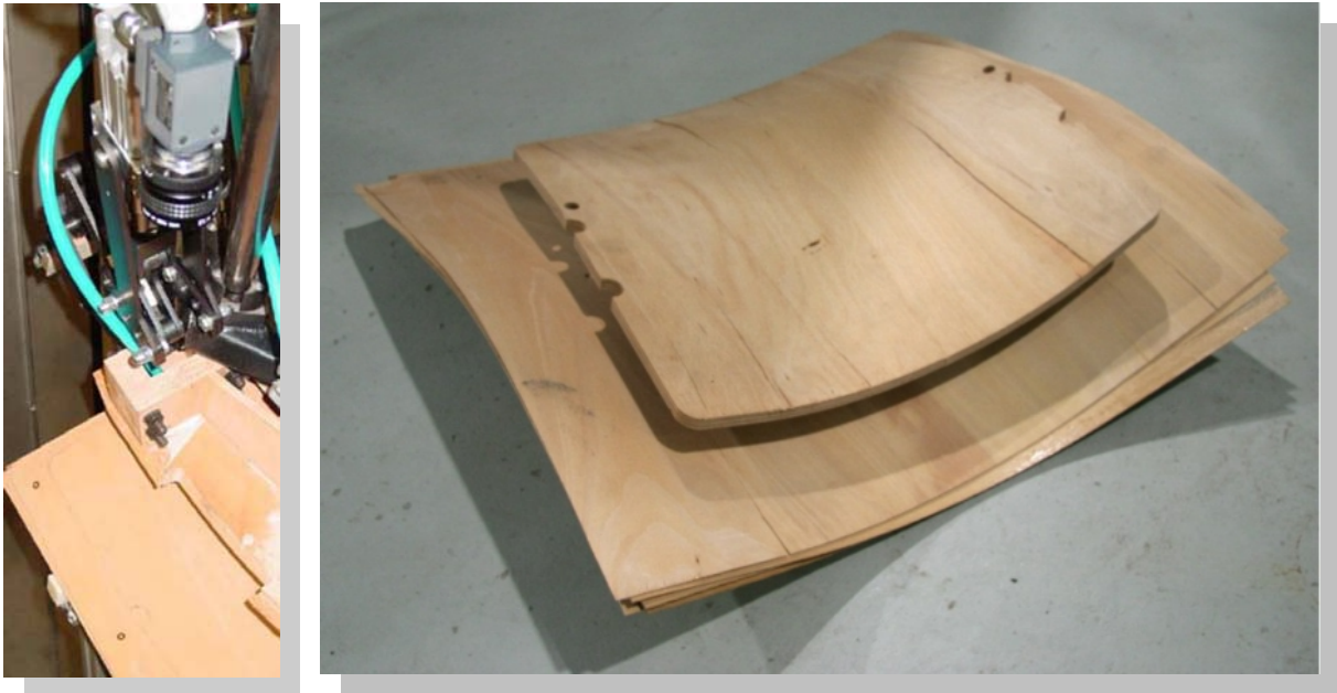
Bildverarbeitung / Rohling und bearbeitetes Werkstück
