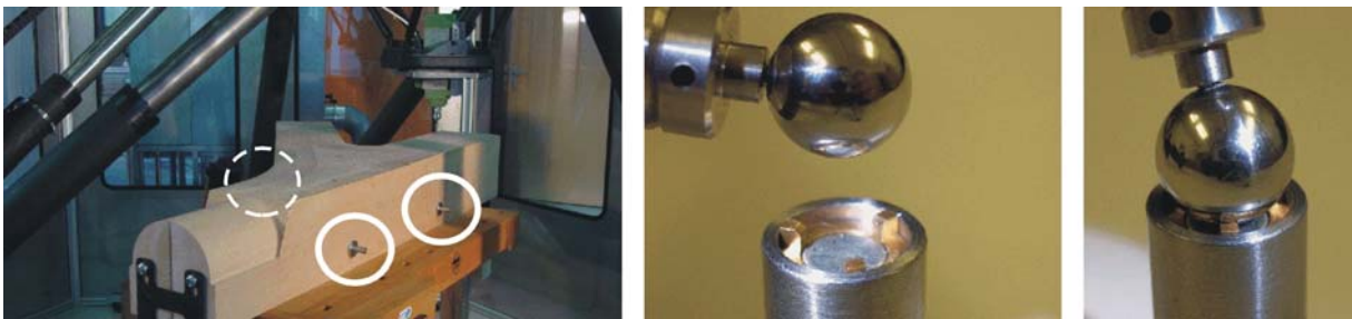
Bild 1: oben: Drei Punkte genügen zur eindeutigen Referenzierung eines Teils unten: Präzisionskugeln in magnetischen Dreipunktaufnahmen als physische Repräsentation der Referenzpunkte
