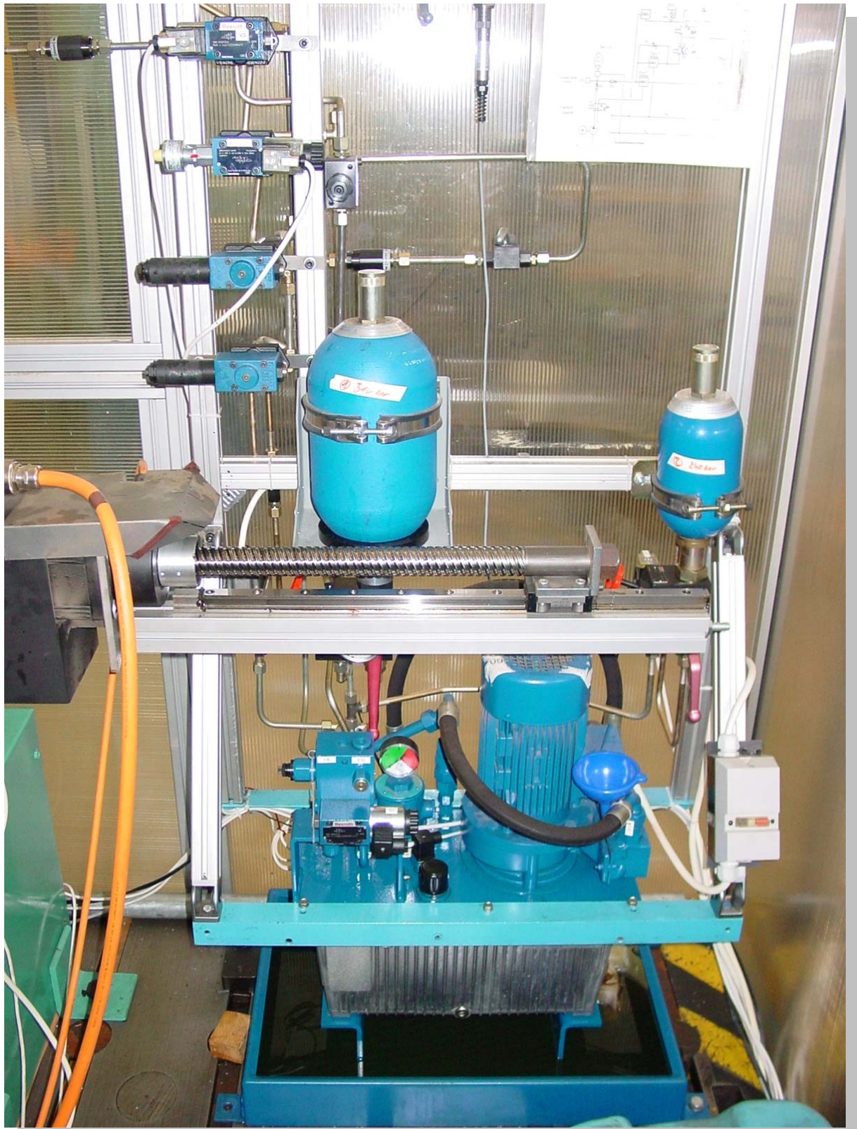
Hydraulik für die Erzeugung pressentypischer Belastungen
