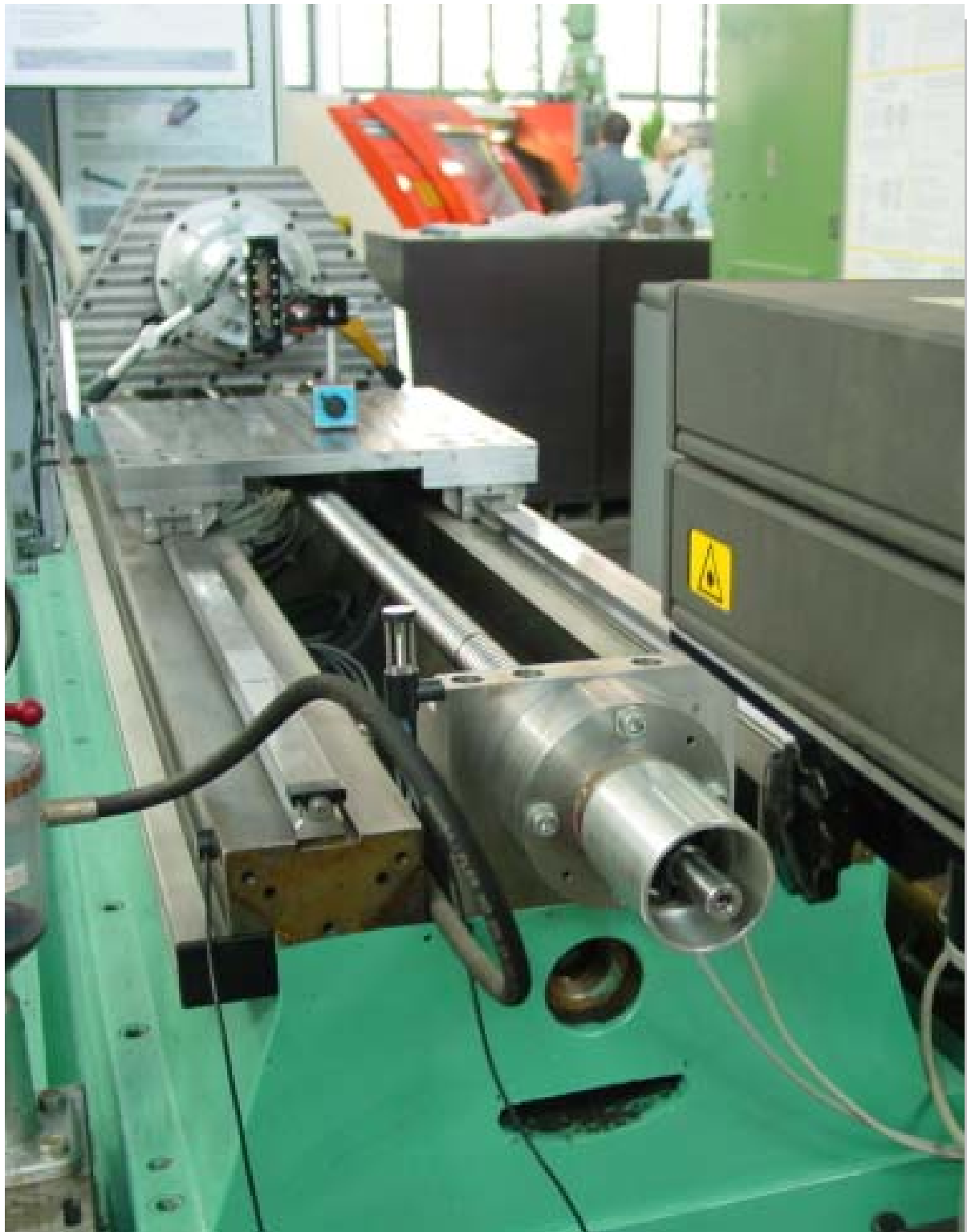
Vorschubachse mit Kugelgewindetrieb
