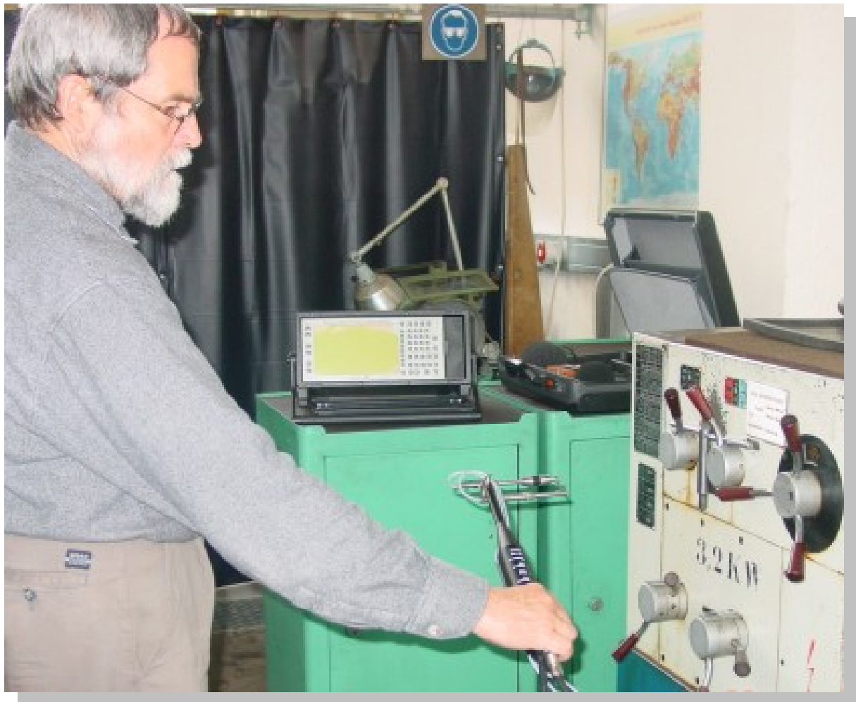
Schallintensitätsmessung an einer Drehmaschine
