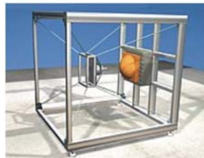
Seilkinematik (parallel, statisch überbestimmt)
