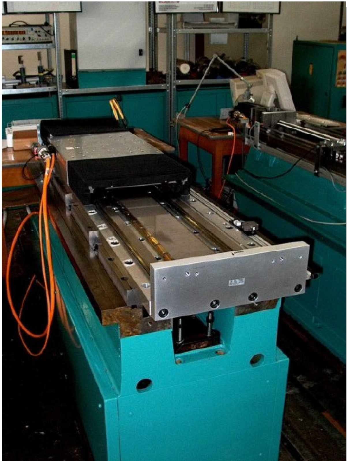
Vorschubachse mit Linear-Direktantrieb
