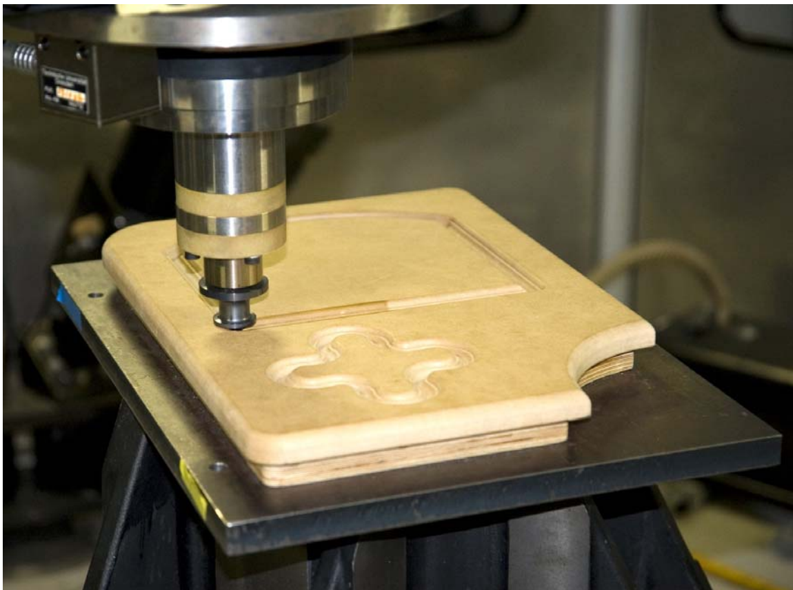
Bild 2: Glätten eines Innenprofils einer MDF-Faserplatte
