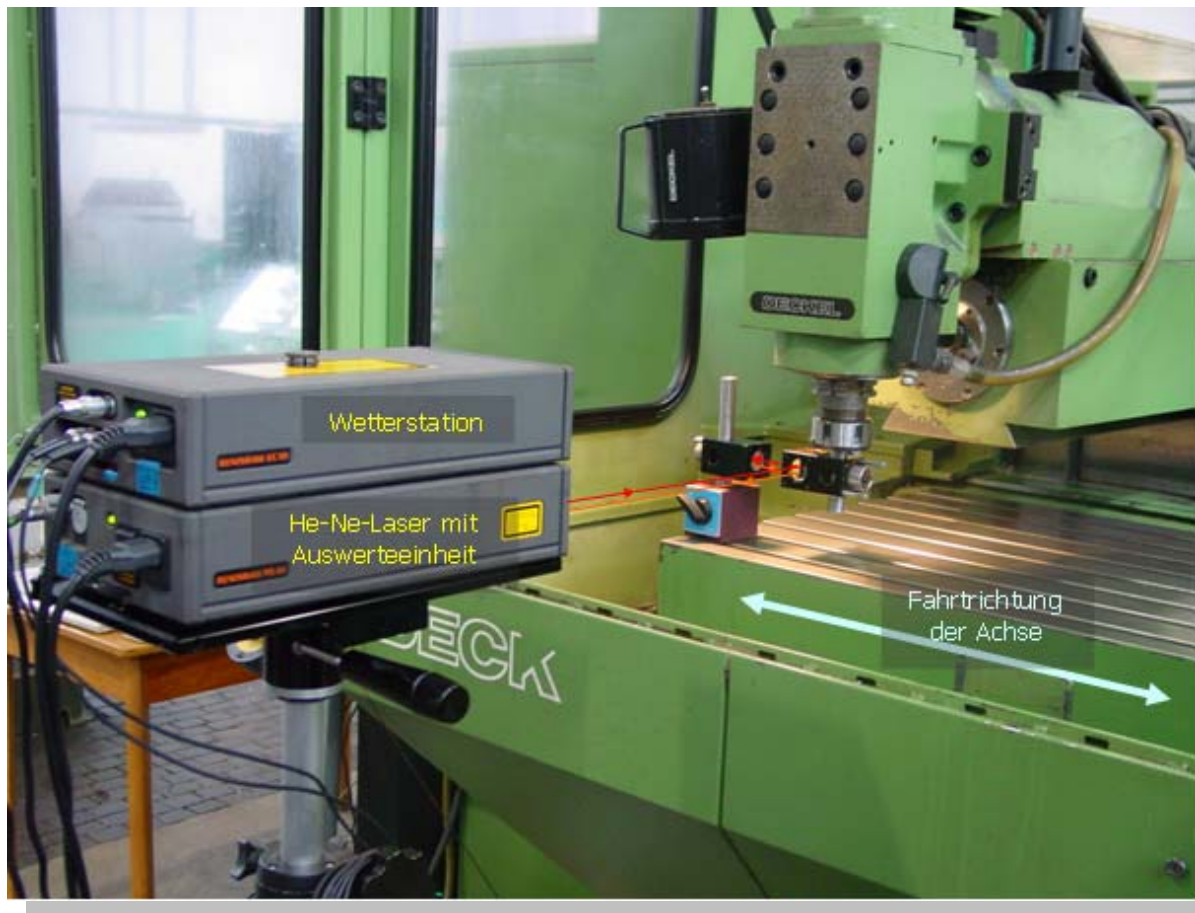
Laser-Interferometer bei einer linearen Verschiebungsmessung
