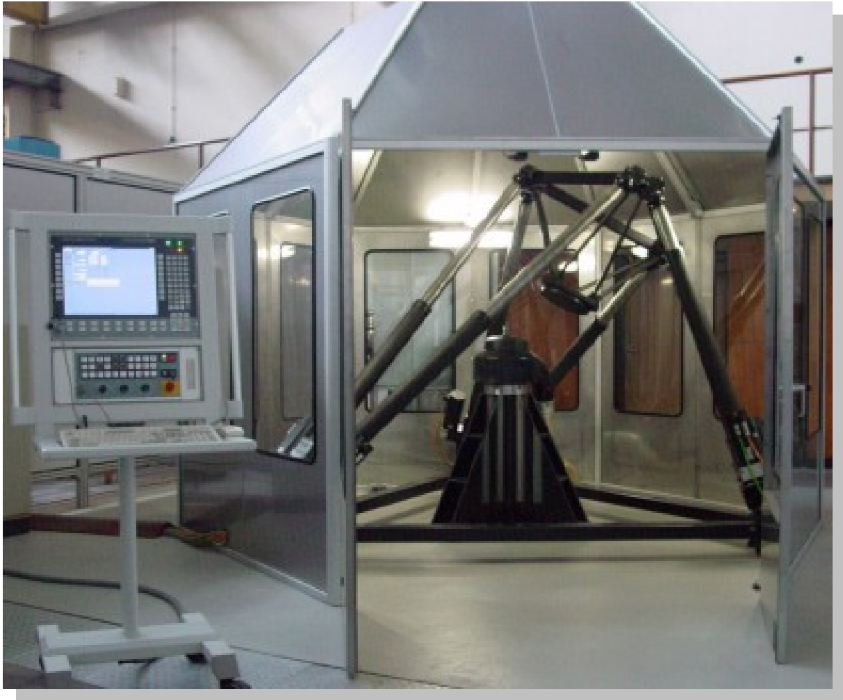
Parallelkinematische Bewegungseinrichtung "Hexapod FELIX"
