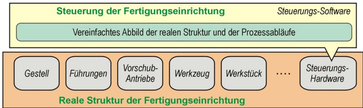
Bild 3: Rolle der Steuerung in der Fertigungseinrichtung
