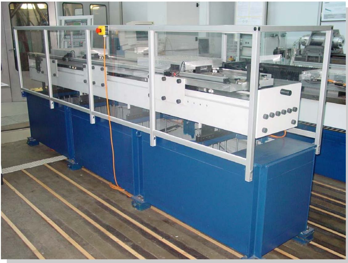
Bild 2: Prüfstand zur Impulsentkopplung
