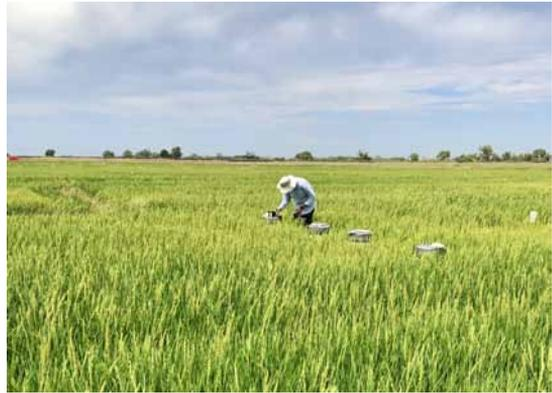
Aktueller Feldversuch in einem Reisfeld in den USA, in dem versucht wird, die Abundanz und Aktivität der Kabelbakterien zu stimulieren. Vier Messkammern dienen der Bestimmung der Methanemissionen verschiedener Behandlungen. Quelle: Vincent Scholz, Tillmann Lueders.
