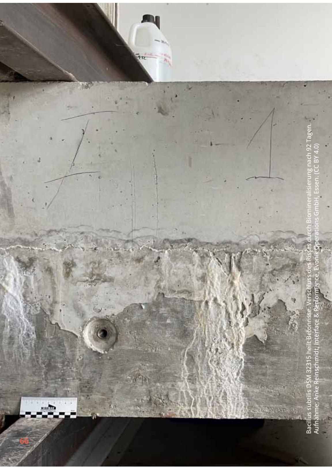
Bacillus subtilis DSM 32315 heilt Betonrisse: Verschluss des Risses durch Biomineralisierung nach 92 Tagen.
