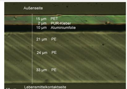
Innenliegende PET- oder Al-Folien bilden Barrieren gegen Gase und Aromastoffe, kaschiert mit Siegelfolien aus PE (bis 100µm), um 1kg Lebensmittel abzufüllen.
