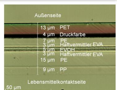
Befüllen mit Gasen (z.B. Sauerstoff) für eine modifizierte Atmosphäre zum Vorbeugen von unerwünschten Lebensmittelveränderungen wie Entstehung von Methmyoglobin bei Fleisch (Graufärbung). EVOH bzw. PA als Gasbarrieren verwendet.
