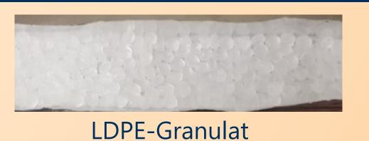
provozierte Oxidation (250 °C, 30 min, Luft)
