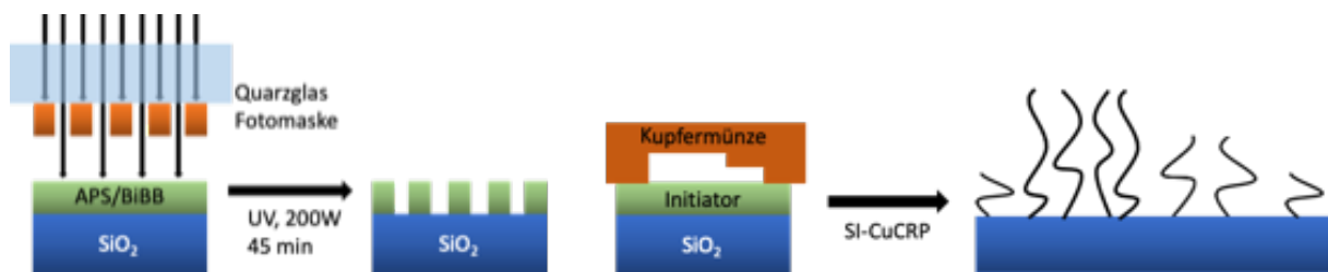
Abbildung 13: Schematische Darstellung der Fotolithographie mittels UV-Licht (links), SI-CuCRP mit Kupfermünze als Kupferquelle (rechts)
