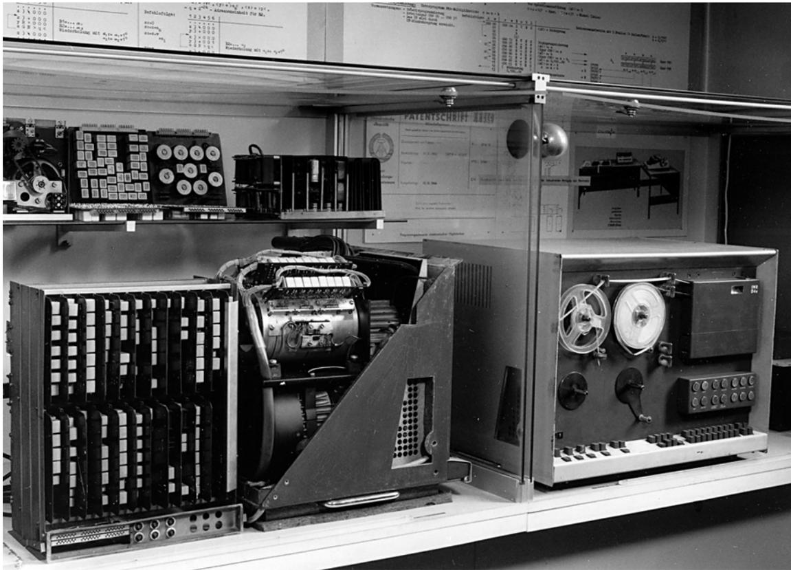
Bild Rechenautomat D4a, unten links im aufgeklappten Zustand
