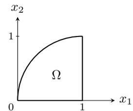
**Lösung** Finite-Differenzen benötigen eine achsen-parallele Geometrie, deshalb ist hier die Finite-Elemente-Methode zu empfehlen.
