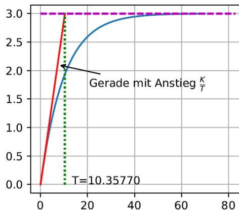
Figure 1: Situation für iii) mit  $K = 3, \tau = 10$  bei  $t_0 = 0$ .
