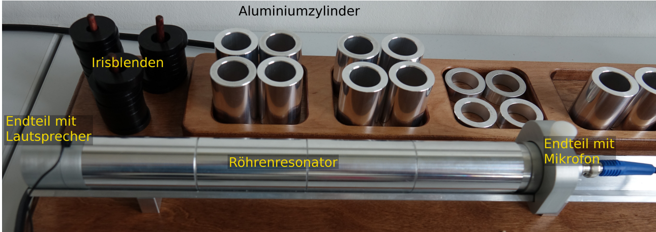
Abbildung 3: Versuchsaufbau Röhrenresonator: durch das Aneinanderreihen von Aluminiumzylindern können Röhrenresonatoren unterschiedlicher Länge aufgebaut werden. Am rechten Ende befindet sich ein Mikrofon, am linken Ende ist ein Lautsprecher eingebaut, über den die Schallwellen in das System eingekoppelt werden.
