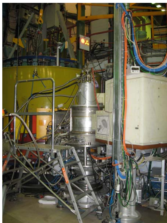
Ein Neutronendiffraktometer am Institut Laue Langevin, Grenoble, Frankreich.
