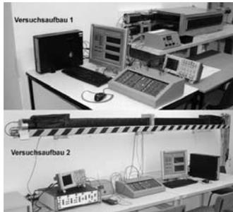
Der Versuch wird in zwei Aufbauten angeboten. Myonen ( $\mu$ -Leptonen) aus der Höhenstrahlung werden entweder in einem Kupferblock (Aufbau 1) oder in einem Szintillatorblock (Aufbau 2) gestoppt. Mit Hilfe von Szintillatorsignalen und elektronisch gemessenen verzögerten Koinzidenzen wird für die gestoppten Teilchen das Zerfallsgesetz und die mittlere Lebensdauer  $\tau_\mu$  bestimmt.
