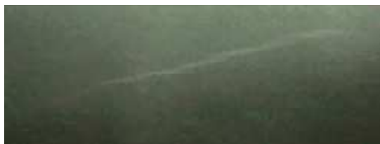
Abbildung 16: Ein Elektron hinterlässt eine kürzere (ca. 1 – 5 Zentimeter) dünne Spur
