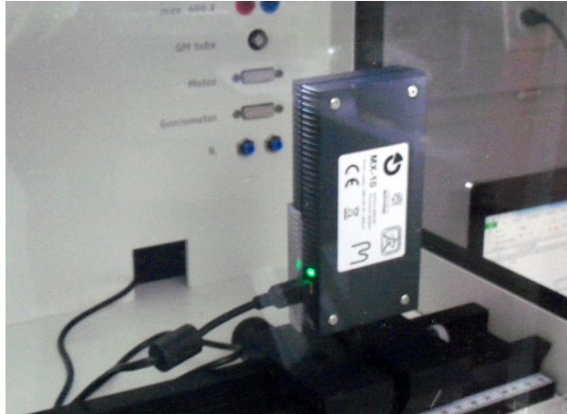
Abbildung 10: Position des Medipix zur Messung der Strahlungsabschwächung an Silizium nach (Bornholdt, 2014)
