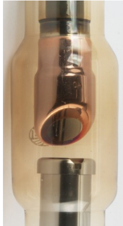
Abbildung 27: Aufbau der Anode der Röntgenröhre nach (Basile, 2014)
