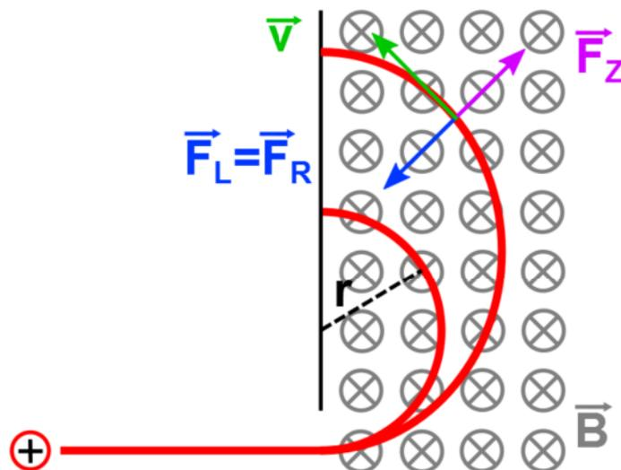
Abbildung 4: Schematischer Aufbau eines Sektorfeldmassenfilters; blau: Lorentzkraft, grün: Geschwindigkeit, violett: Zentrifugalkraft
